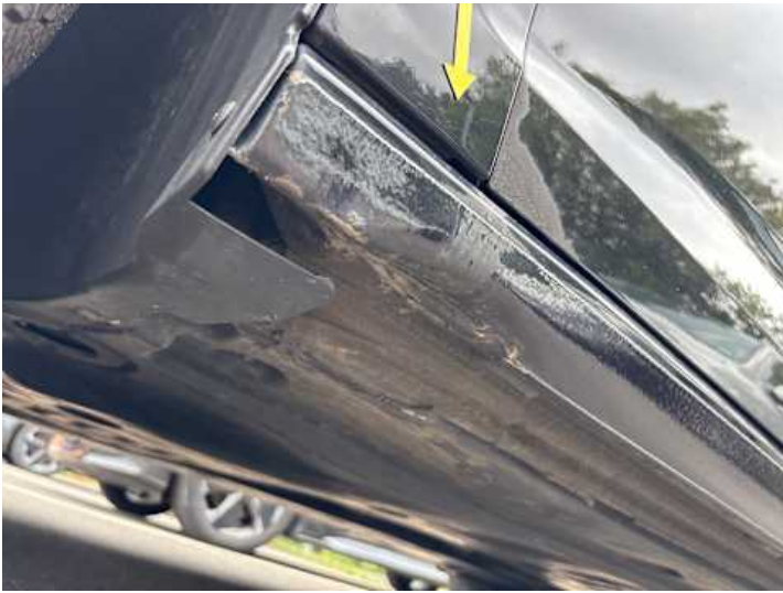
Schweller links (Lackschaden, Delle)
