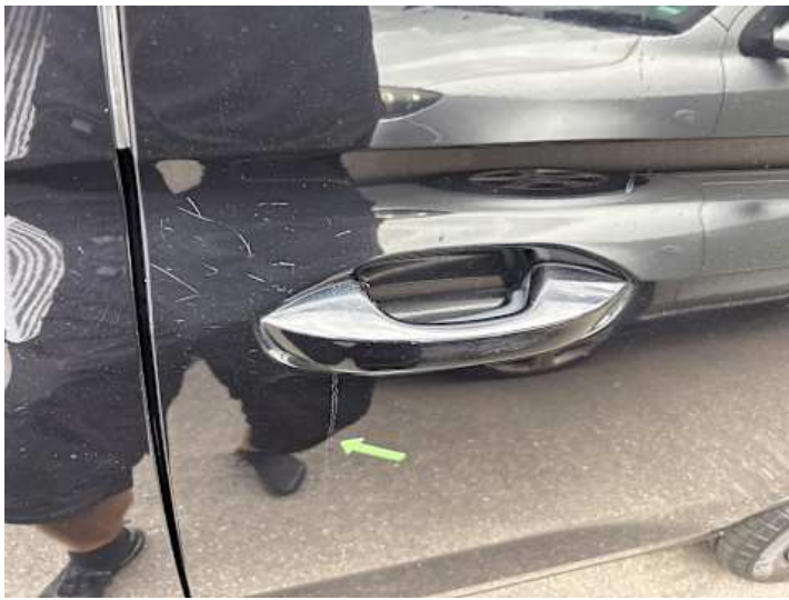
Türe hinten links (Kratzer)
