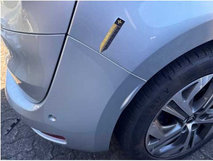
Stoßstange hinten (Unsachgemäß instand gesetzt)
