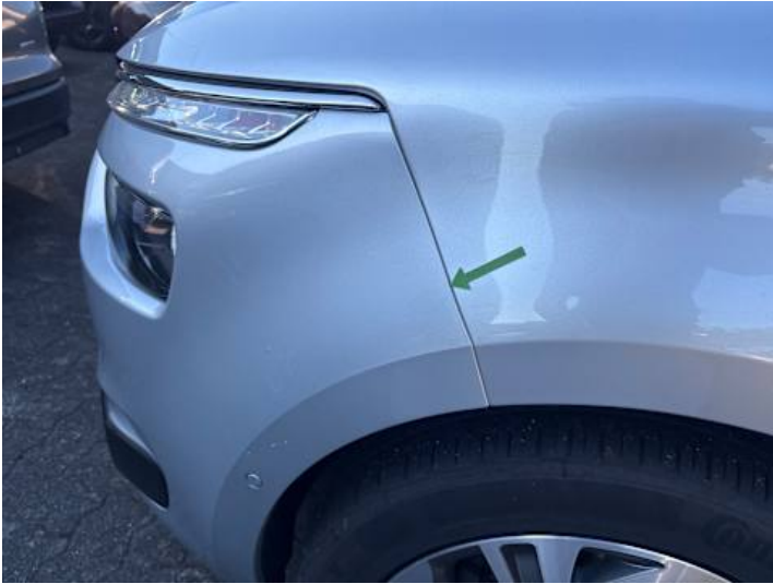
Stoßstange vorne (Unsachgemäß instand gesetzt)
