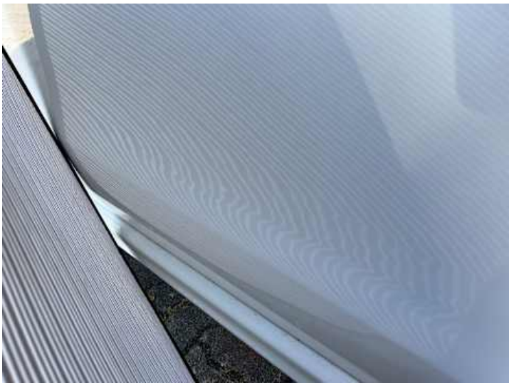
Türe hinten rechts (Unsachgemäß instand gesetzt)
