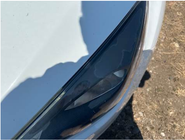
Scheinwerfer (links) (Anderer Schaden): Schutzfolie löst sich
