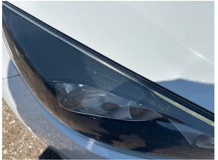
Scheinwerfer (rechts) (Anderer Schaden): Schutzfolie löst sich
