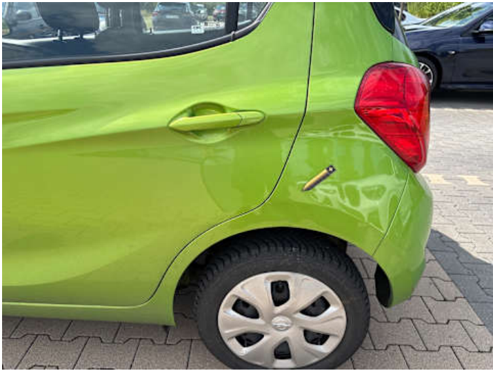
Seitenteil hinten links (Verformung, Lackschaden)
