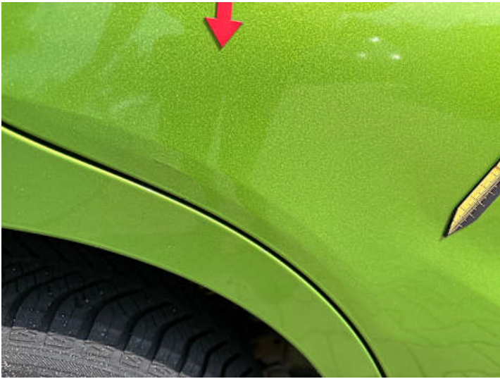
Türe hinten rechts (Lackschaden, Verformung, Delle)
