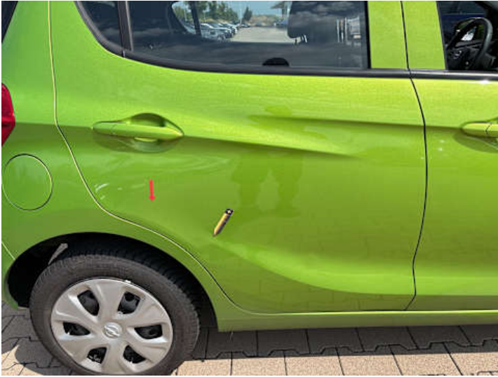
Türe hinten rechts (Lackschaden, Verformung, Delle)
