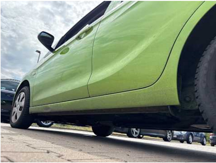
Schweller links (Verformung, Kratzer)
