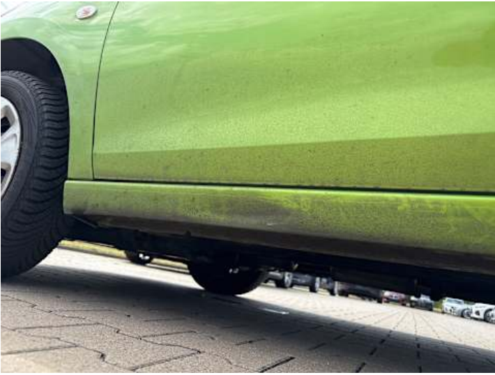
Schweller links (Verformung, Kratzer)
