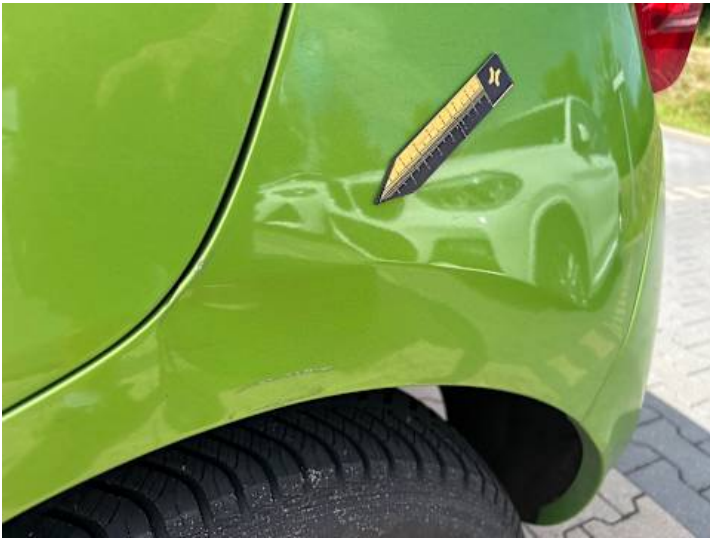
Seitenteil hinten links (Verformung, Lackschaden)
