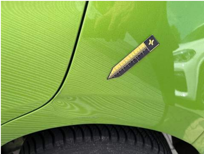
Seitenteil hinten links (Verformung, Lackschaden)
