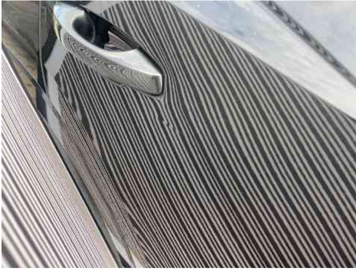
Türe hinten rechts (Delle)
