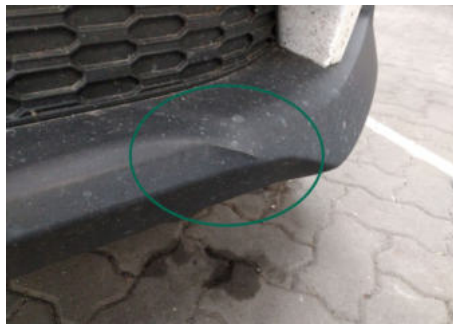
Stoßfänger unterhalb / Vorne / Delle
