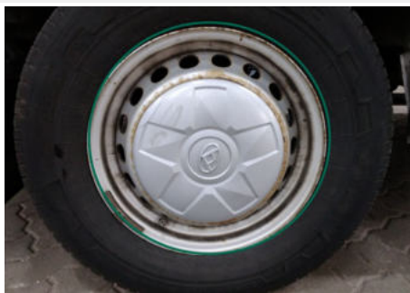
Felge / Hinten Rechts / Rost
