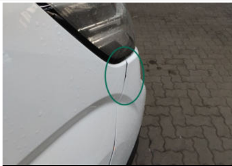
Stoßfängerhalter / Vorne Rechts / Defekt
