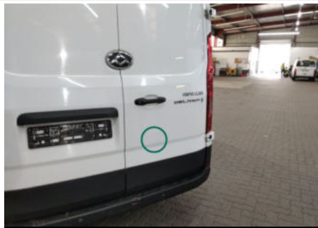
Heckklappe / Kofferraumtür / Unten Rechts / Delle
