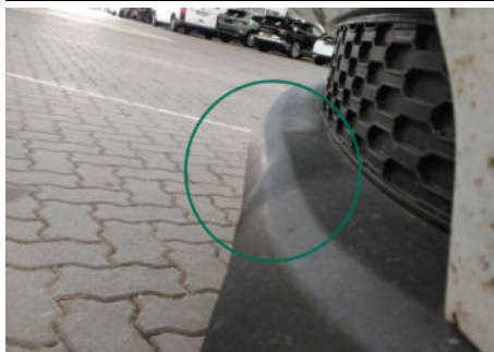
Stoßfänger unterhalb / Vorne / Delle
