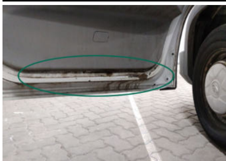
Tür / Innenraum Vorne Links / Abgewetzt
