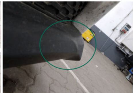
Stoßfänger unterhalb / Vorne / Delle
