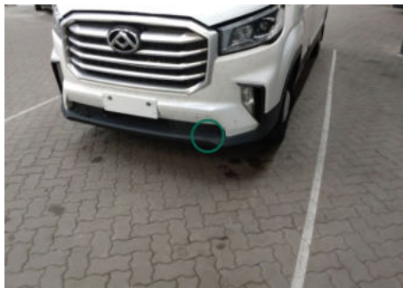
Stoßfänger unterhalb / Vorne / Delle
