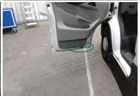
Tür / Innenraum Vorne Links / Abgewetzt
