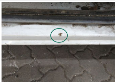
Türeinstieg / Rechts / Rost
