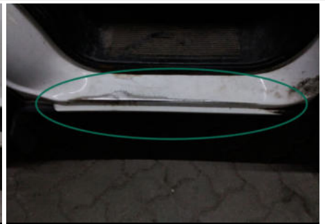
Türeinstieg / Vorne Links / Abgewetzt
