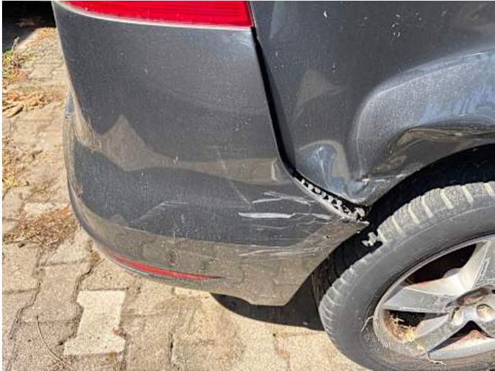
Stoßstange hinten (Riss/Bruch, Verformung)
