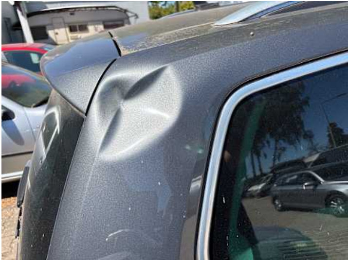
Seitenteil hinten rechts (Verformung, Kratzer)
