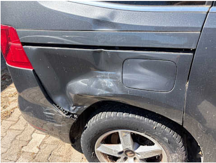
Seitenteil hinten rechts (Verformung, Kratzer)
