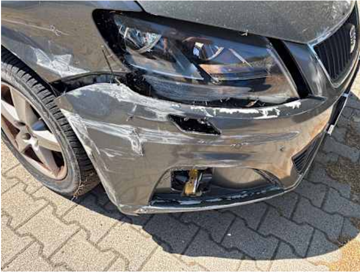
Stoßstange vorne (Riss/Bruch)
