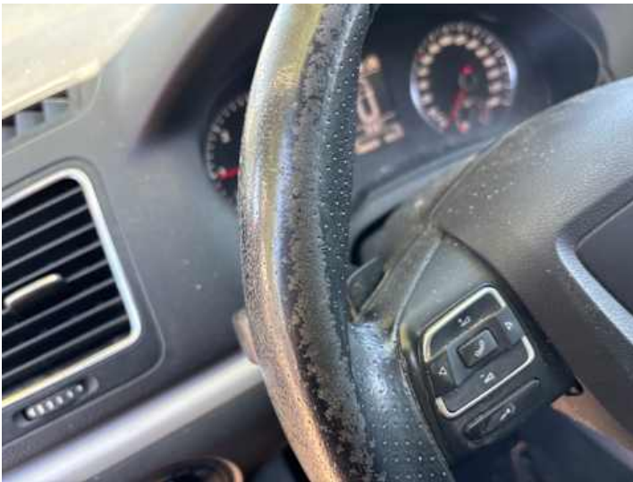
Innenraum (Verschmutzung, Anderer Schaden, Tierhaare/Tiergeruch, Verschleiß): Schimmel
