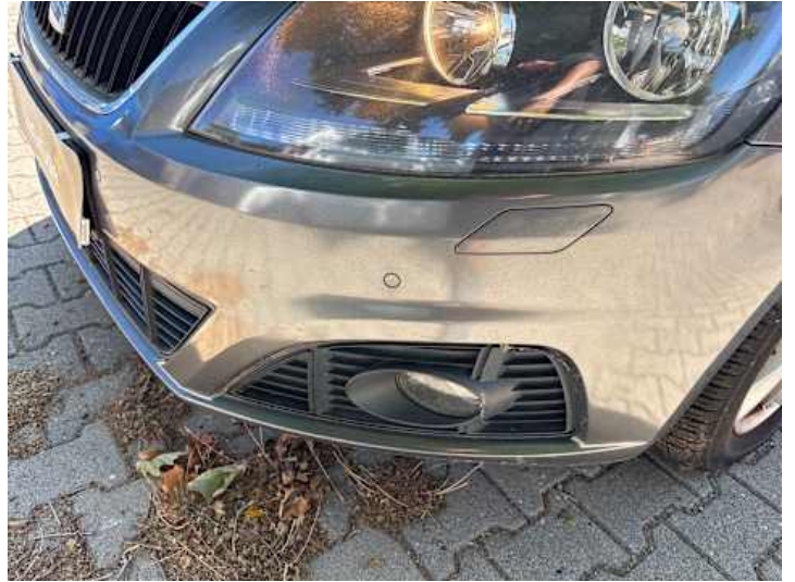
Stoßstange vorne (Lackschaden, Unsachgemäß instand gesetzt)
