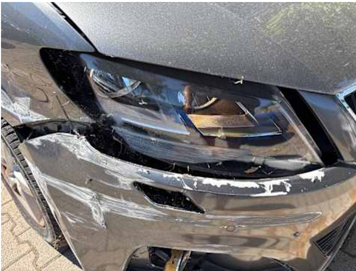
Scheinwerfer (rechts) (Riss/Bruch, Kratzer)
