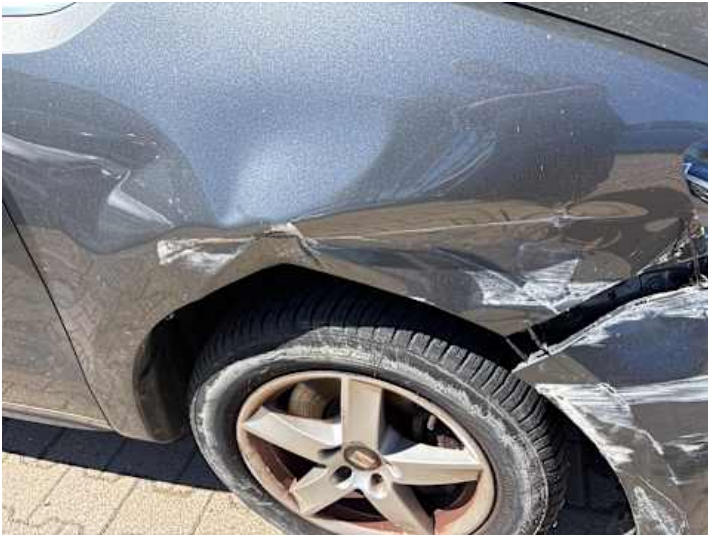
Kotflügel vorne rechts (Verformung, Kratzer, Riss/Bruch)
