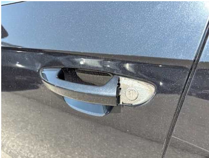
Fahrtür (Anderer Schaden): Abdeckung fehlt
