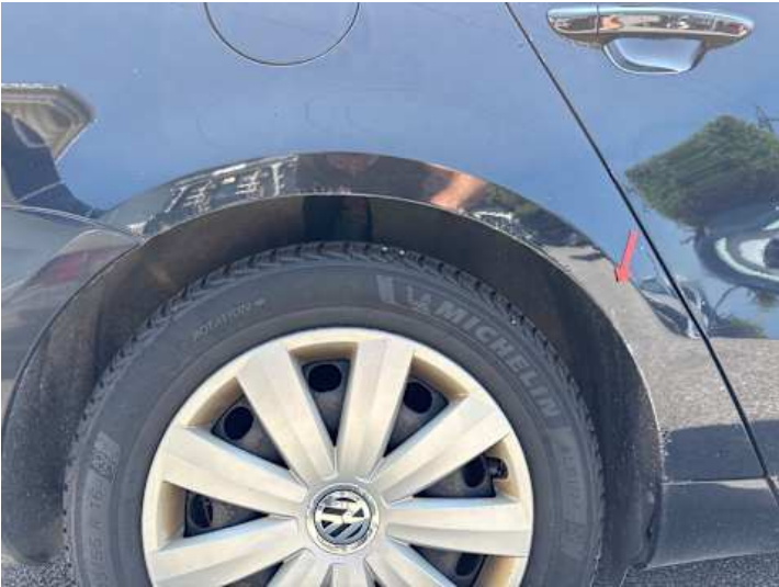
Seitenteil hinten rechts (Rost)
