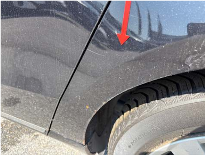
Seitenteil hinten links (Rost)
