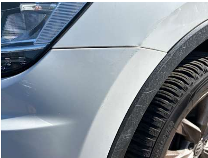
Stoßstange vorne (Kratzer, Riss/Bruch)
