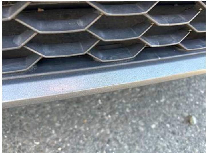
Stoßstange vorne (Kratzer, Riss/Bruch)
