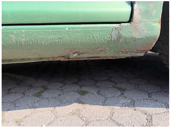
Schweller rechts (Rost, Lackschaden)
