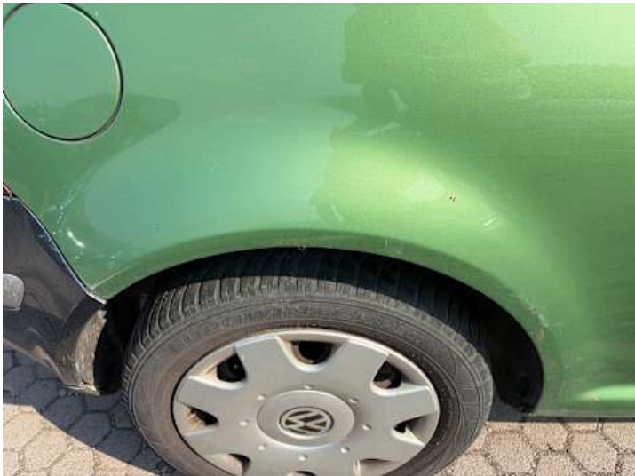
Seitenteil hinten rechts (Rost, Kratzer, Lackschaden)
