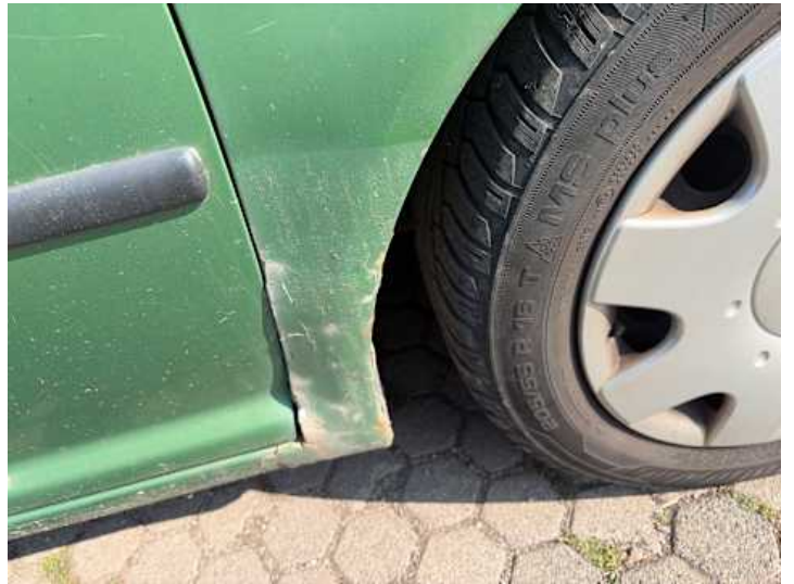
Kotflügel vorne rechts (Rost, Lackschaden)
