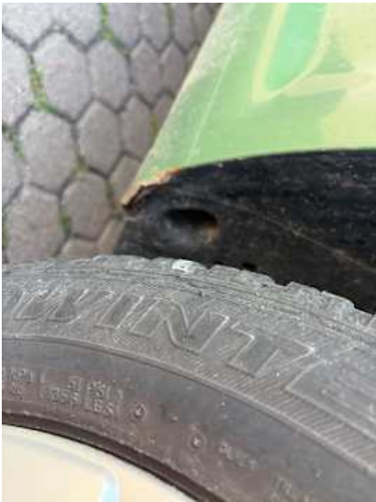
Seitenteil hinten links (Rost)
