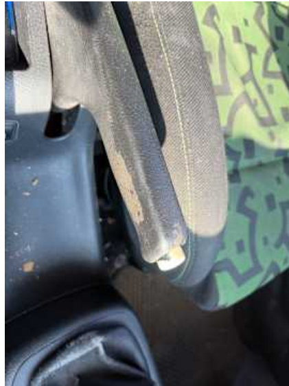
Innenraum (Verschleiß, Riss/Bruch)
