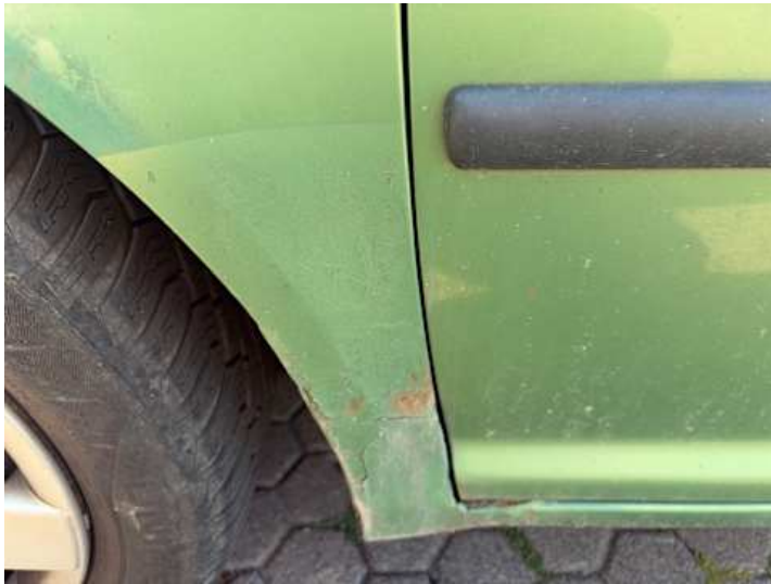
Kotflügel vorne links (Rost, Lackschaden)
