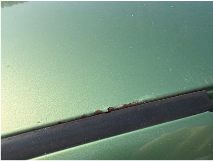
Dach (Lackschaden, Rost)
