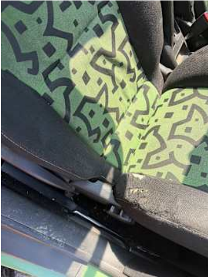
Innenraum (Verschleiß, Riss/Bruch)
