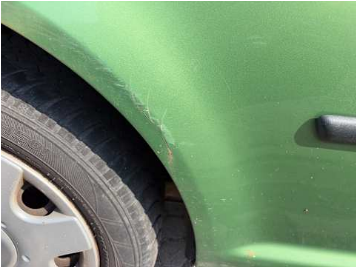
Seitenteil hinten rechts (Rost, Kratzer, Lackschaden)
