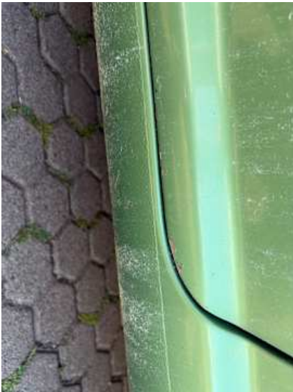
Fahrertür (Lackschaden, Rost)
