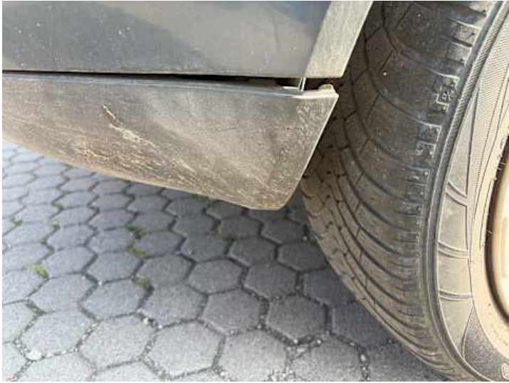
Stoßstange hinten (Spaltmaße ungenau, Riss/Bruch)
