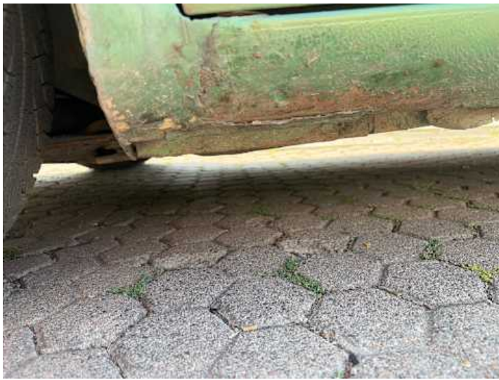
Schweller links (Rost, Lackschaden, Verformung)
