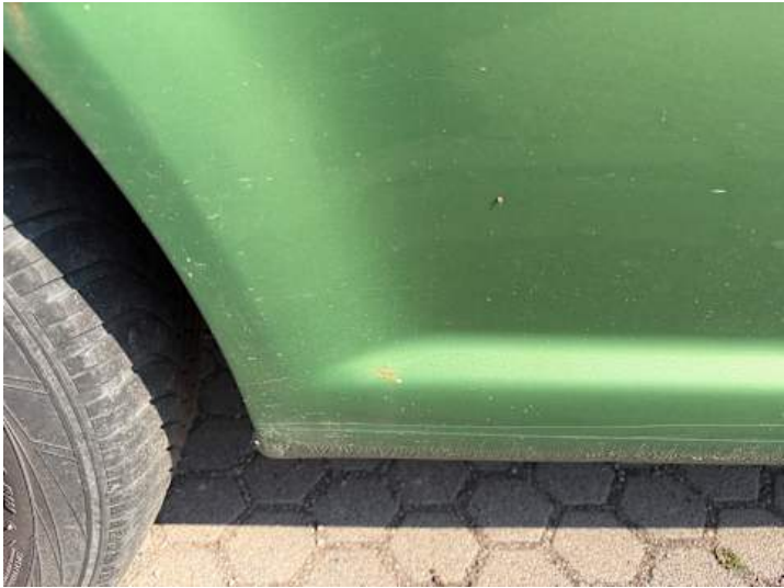
Seitenteil hinten rechts (Rost, Kratzer, Lackschaden)
