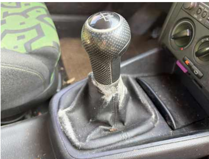
Innenraum (Verschleiß, Riss/Bruch)
