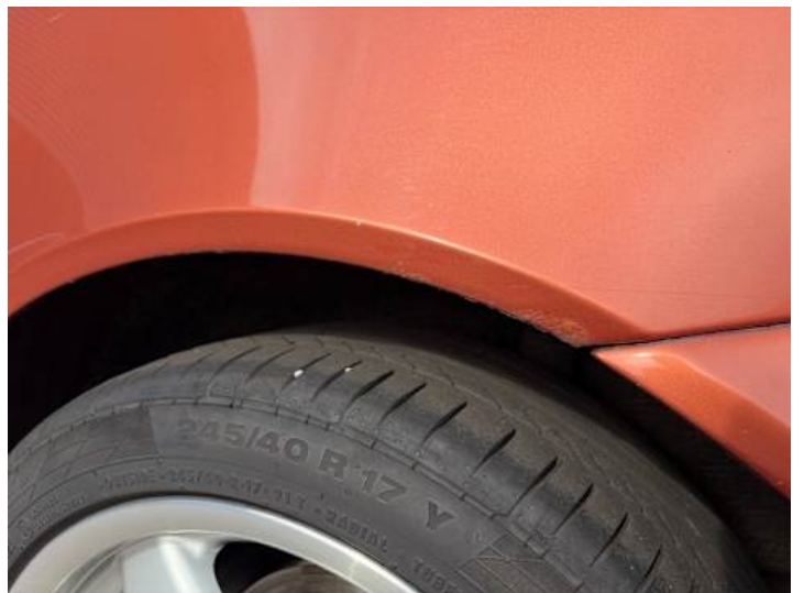
Seitenteil hinten links (Rost, Kratzer)
