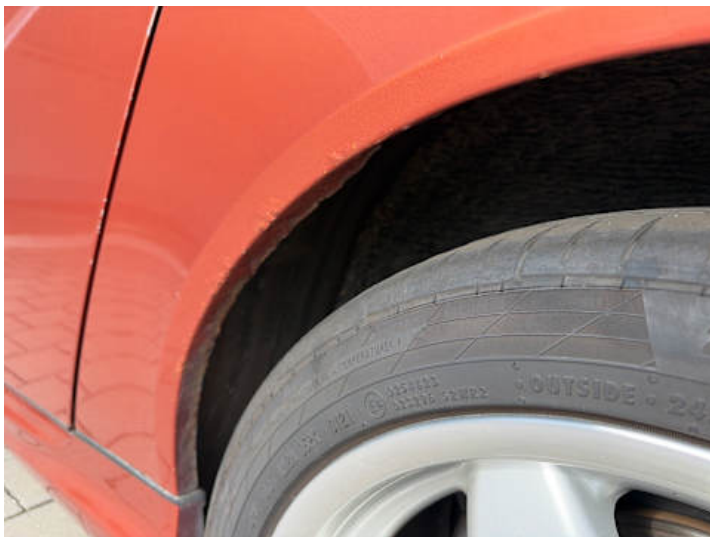
Seitenteil hinten links (Rost, Kratzer)
