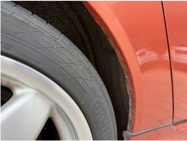
Seitenteil hinten rechts (Rost)
