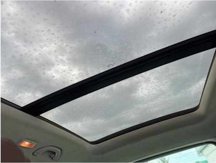
Innenraum (Anderer Schaden): Rollo defekt
