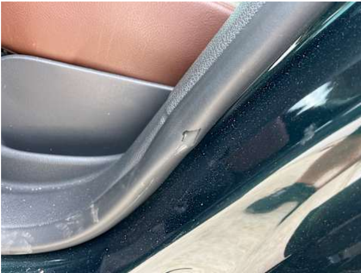
Seitenteil hinten links (Riss/Bruch)
