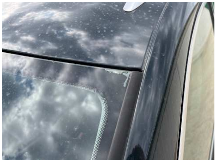
Windschutzscheibe (Anderer Schaden): Ablösung
