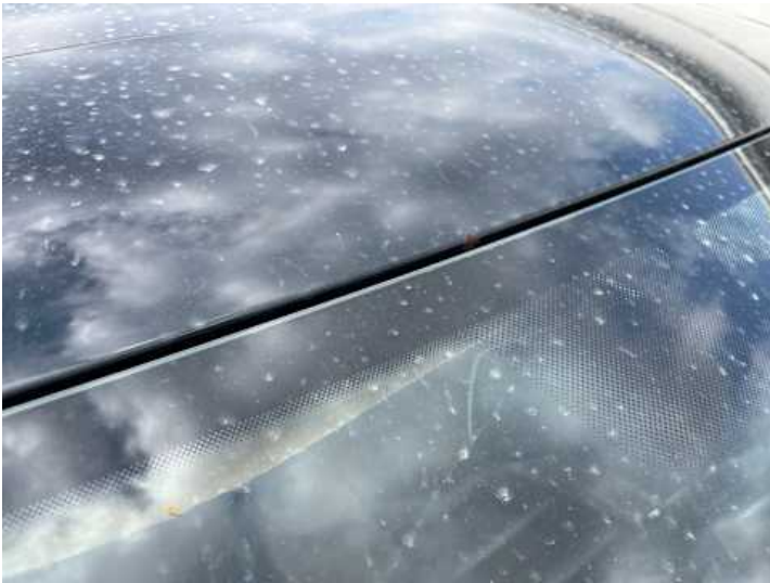
Dach (Steinschlag, Rost)
