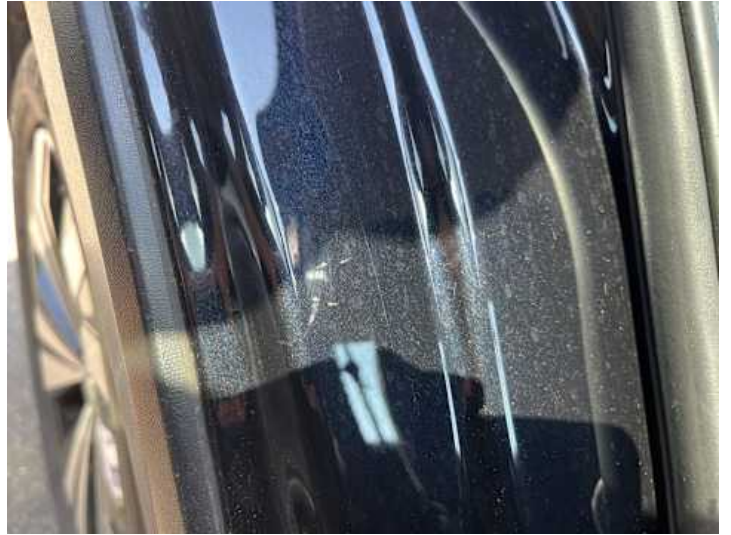
Seitenteil hinten rechts (Lackschaden, Kratzer)
