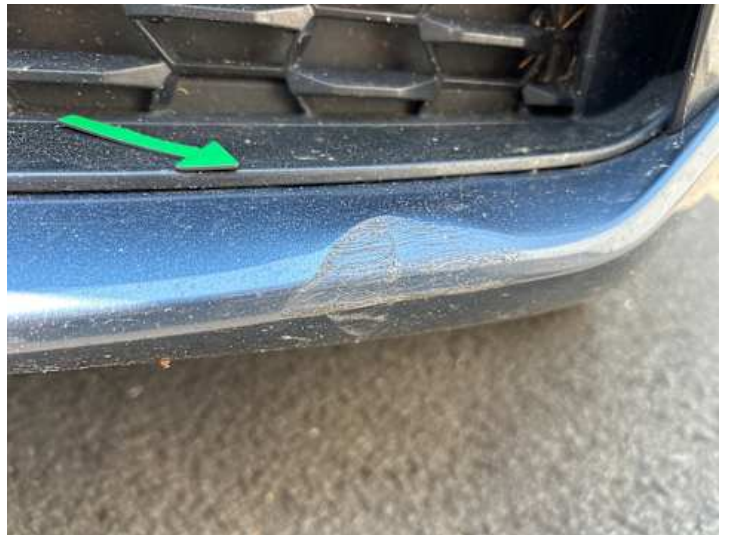
Stoßstange vorne (Kratzer, Verformung)
