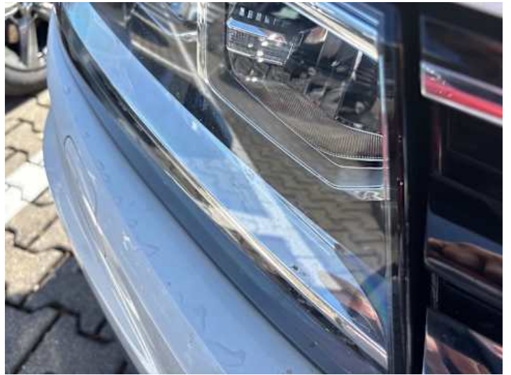
Scheinwerfer (rechts) (Steinschlag)
