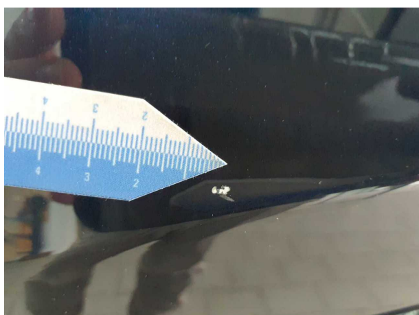
Gebrauchsspur 6: Kotflügel links: Kotflügel links - Steinschlag - auslegen / polieren
