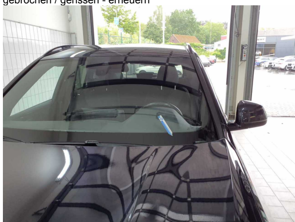
Beschädigung 8: Verglasung: Frontscheibe - gebrochen / gerissen - erneuern
