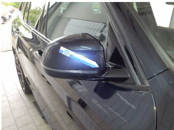
Beschädigung 4: Außenspiegel rechts: Abdeckkappe - gebrochen / gerissen - erneuern
