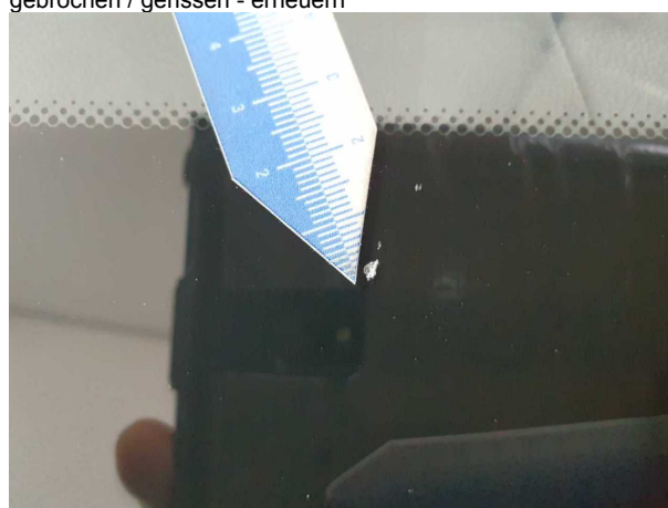
Beschädigung 8: Verglasung: Frontscheibe - gebrochen / gerissen - erneuern
