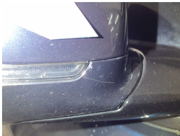
Beschädigung 4: Außenspiegel rechts: Abdeckkappe - gebrochen / gerissen - erneuern
