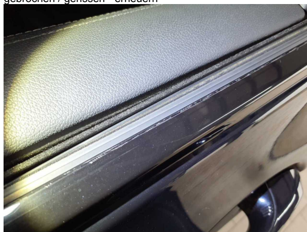
Beschädigung 3: Tür vorn links: Zierleiste oben (Vorschaden) - Kratzer - erneuern
