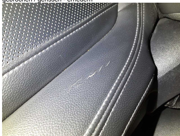
Beschädigung 5: Sitz vorn: Sitzbezug links - gebrochen / gerissen - Smart Repair
