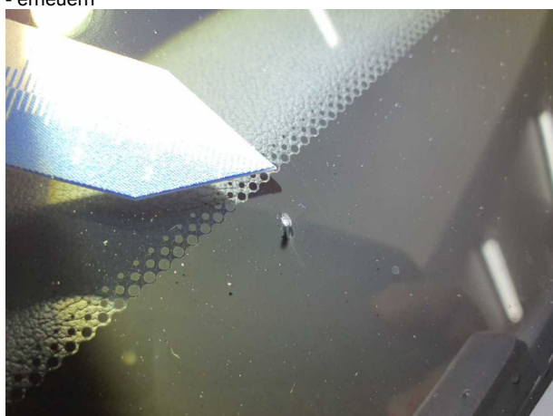
Beschädigung 8: Verglasung: Frontscheibe - gebrochen / gerissen - erneuern
