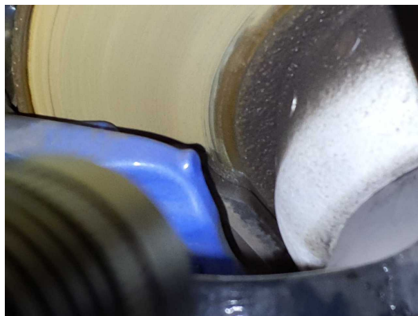
Gebrauchsspur 1: Bremsanlage: Bremsscheiben und Beläge hinten (Nahe der Verschleißgrenze) - kein Abzug
