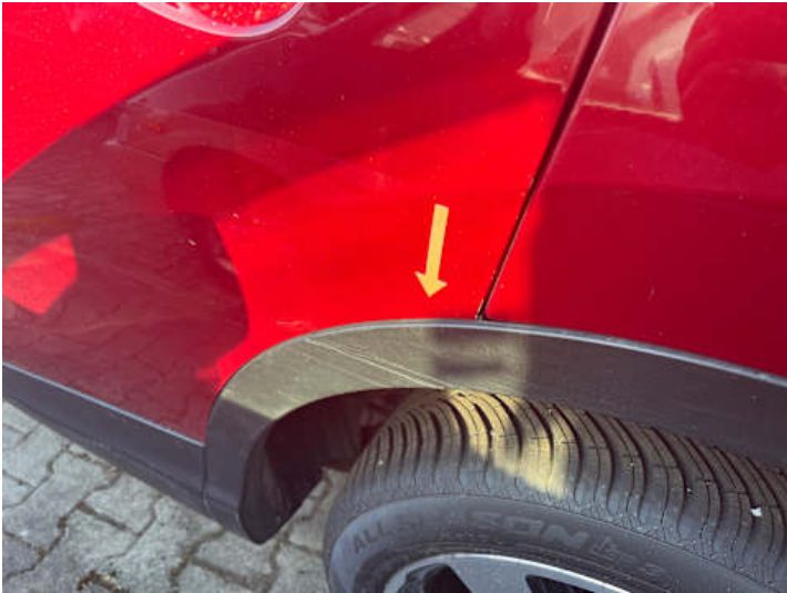
Türe hinten links (Lackschaden)
