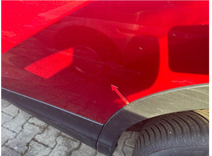
Türe hinten links (Lackschaden)
