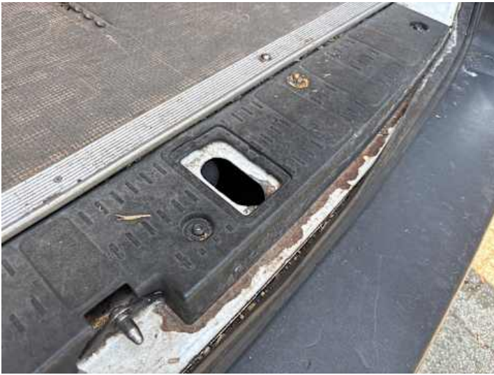
Stoßstange hinten (Rost)
