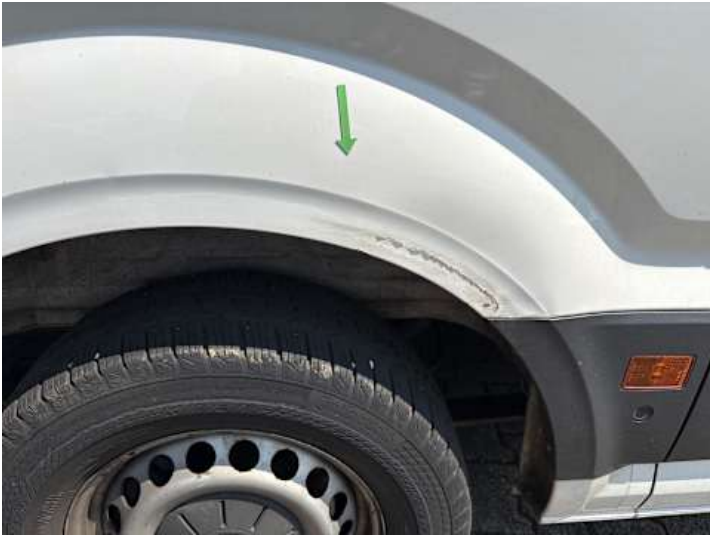
Seitenteil hinten rechts (Verformung, Lackschaden)
