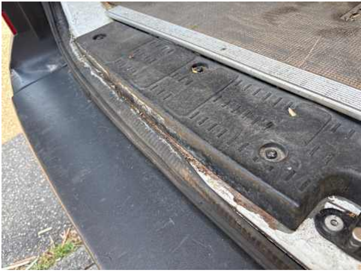
Stoßstange hinten (Rost)
