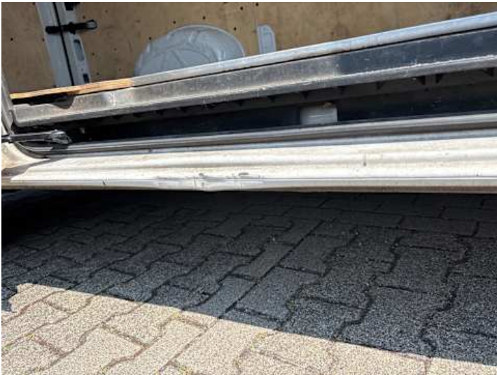
Schweller rechts (Verformung, Lackschaden)
