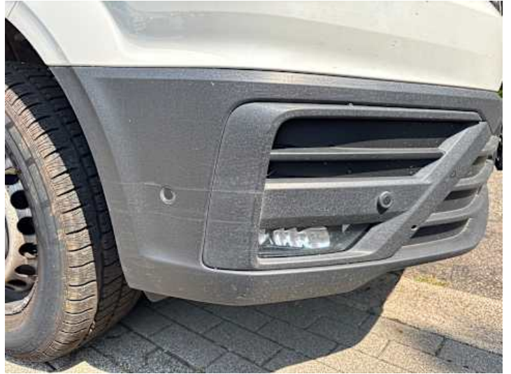
Stoßstange vorne (Kratzer, Verformung)
