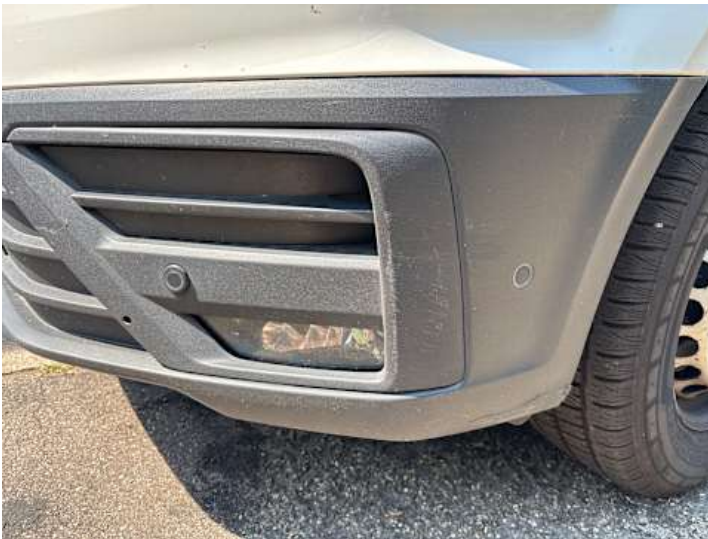
Stoßstange vorne (Kratzer, Verformung)
