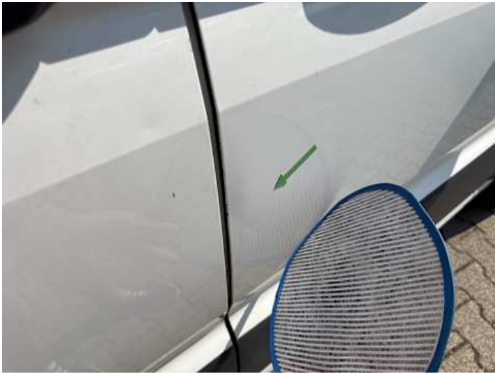
Beifahrertür (Kratzer, Delle)
