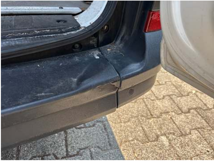
Stoßstange hinten (Riss/Bruch, Verformung)
