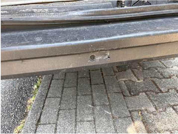
Stoßstange hinten (Riss/Bruch, Verformung)
