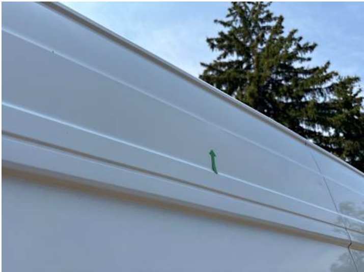
Seitenteil hinten links (Verformung, Kratzer)
