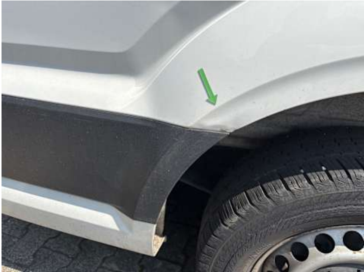
Seitenteil hinten rechts (Verformung, Lackschaden)
