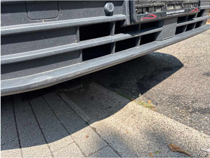
Stoßstange vorne (Kratzer, Verformung)
