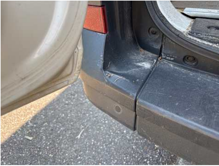
Stoßstange hinten (Riss/Bruch, Verformung)
