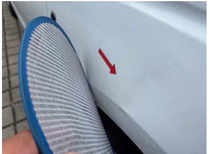
Kotflügel vorne rechts (Verformung)
