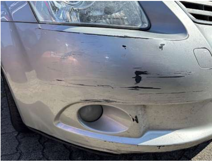
Stoßstange vorne (Kratzer, Verformung)
