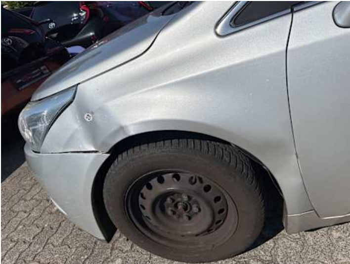
Kotflügel vorne links (Spaltmaße ungenau, Verformung, Kratzer)
