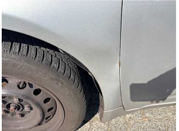
Kotflügel vorne links (Spaltmaße ungenau, Verformung, Kratzer)
