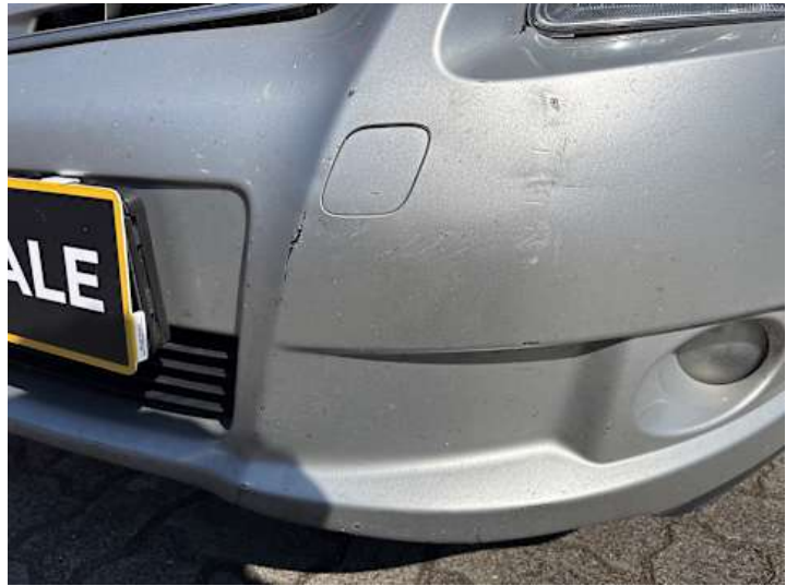
Stoßstange vorne (Kratzer, Verformung)
