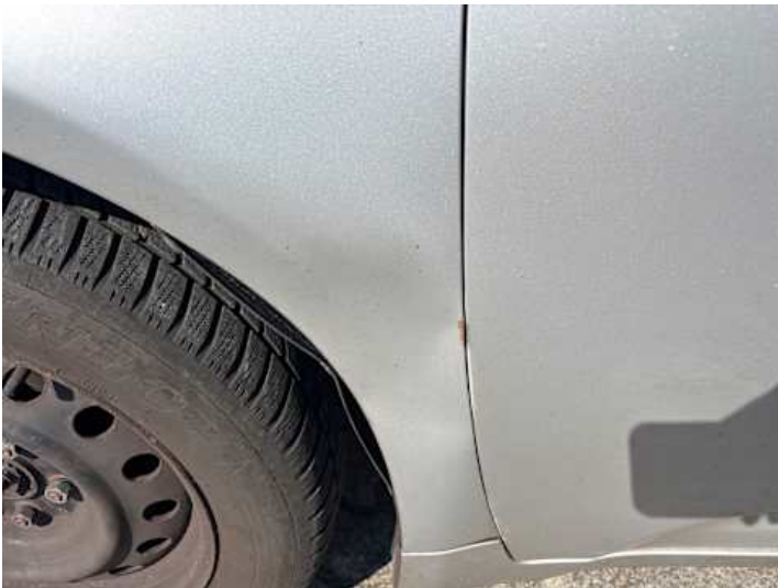
Fahrtür (Spaltmaße ungenau)
