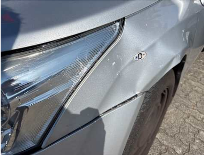
Kotflügel vorne links (Spaltmaße ungenau, Verformung, Kratzer)
