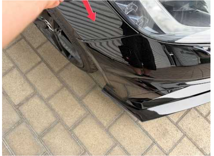
Stoßstange vorne (Spaltmaße ungenau)
