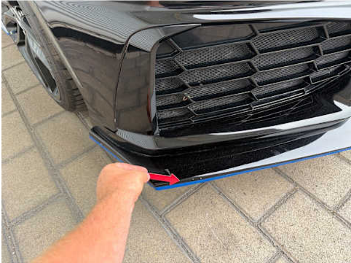
Stoßstange vorne (Steinschlag)
