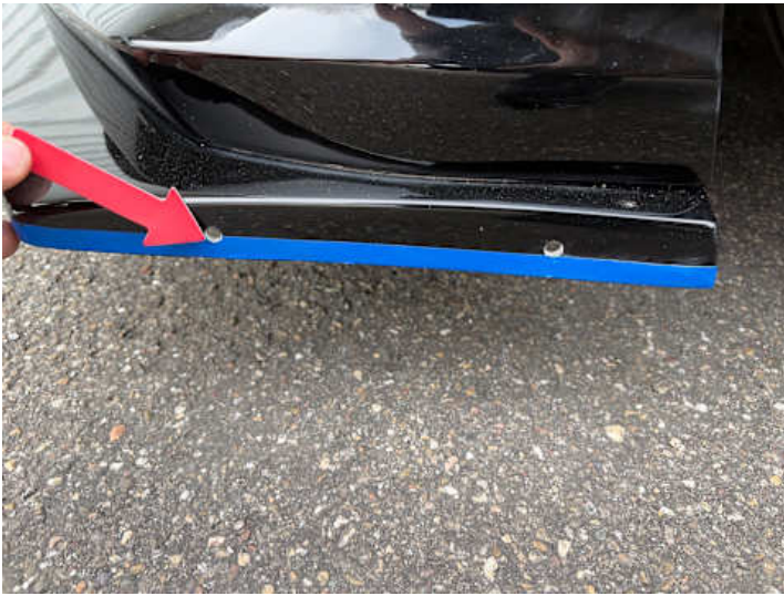
Stoßstange vorne (Anderer Schaden): Löcher
