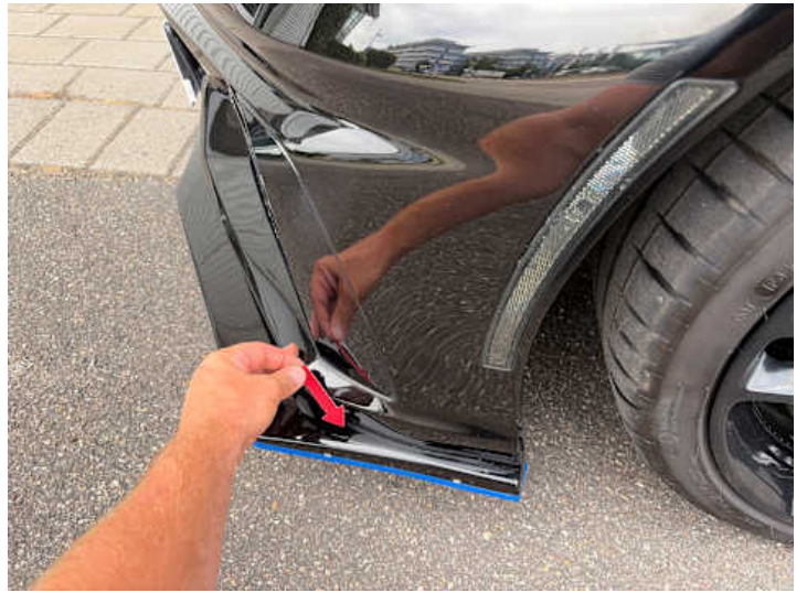
Stoßstange vorne (Anderer Schaden): Löcher
