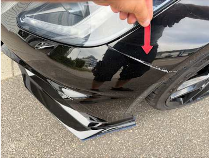
Stoßstange vorne (Spaltmaße ungenau)
