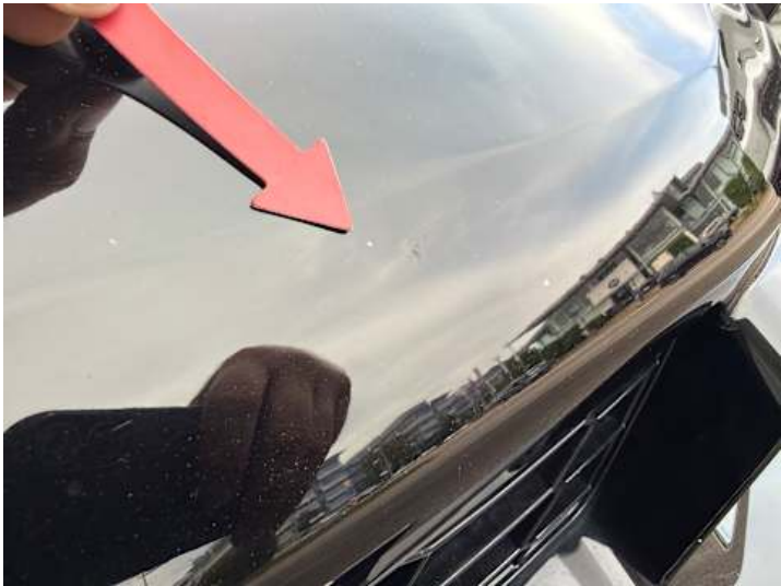
Stoßstange vorne (Steinschlag)
