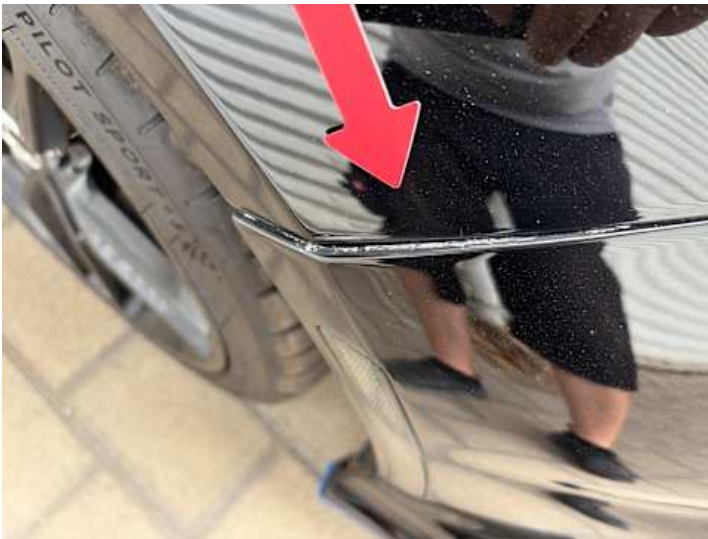
Stoßstange vorne (Spaltmaße ungenau)
