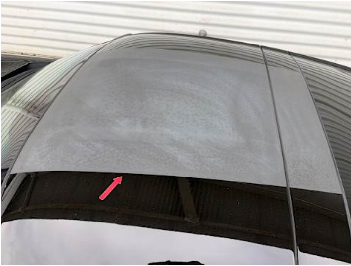
Dach (Anderer Schaden): Aufkleber matt
