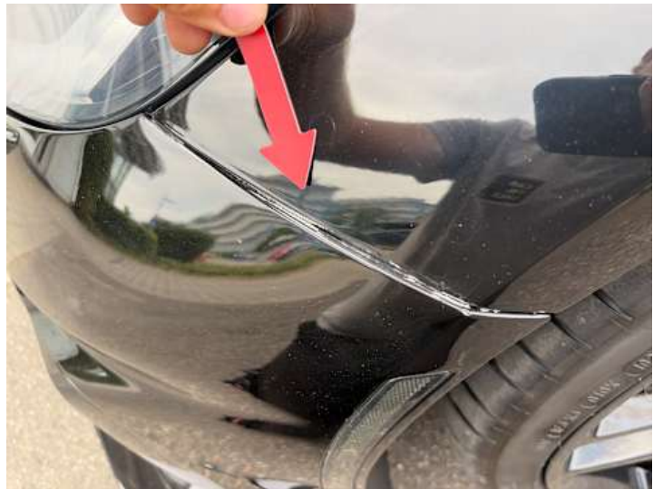
Stoßstange vorne (Spaltmaße ungenau)
