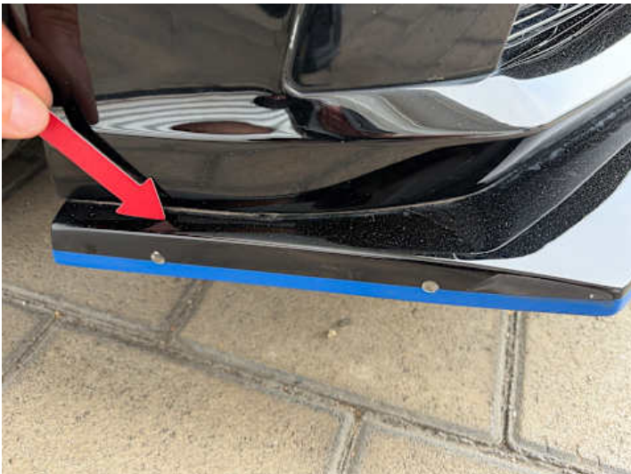
Stoßstange vorne (Anderer Schaden): Löcher
