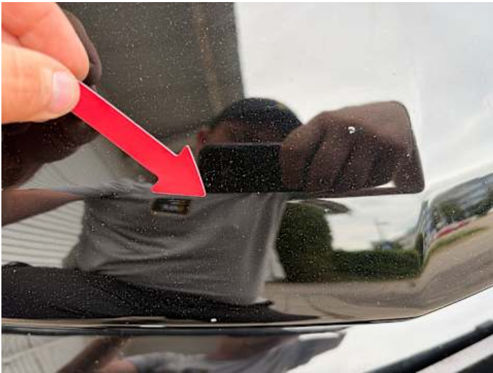
Stoßstange vorne (Steinschlag)
