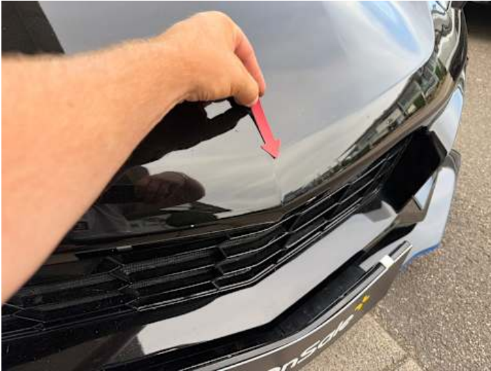
Stoßstange vorne (Steinschlag)
