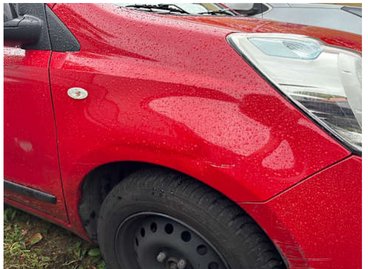
Kotflügel vorne rechts (Kratzer, Delle)
