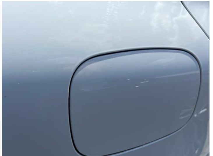
Seitenteil hinten rechts (Spaltmaße ungenau)
