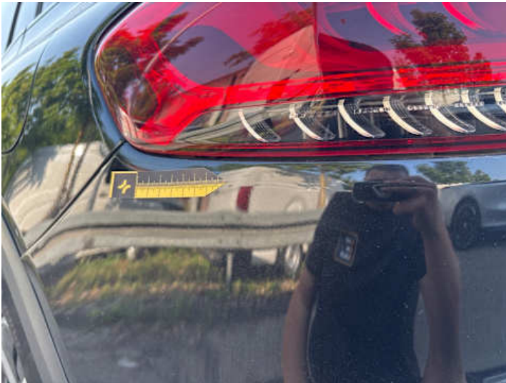
Stoßstange hinten (Unsachgemäß instand gesetzt)
