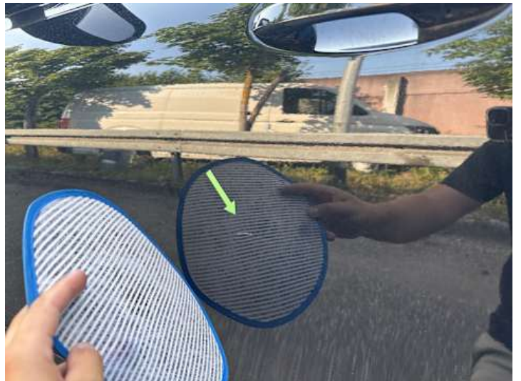
Fahrtür (Kratzer, Delle)
