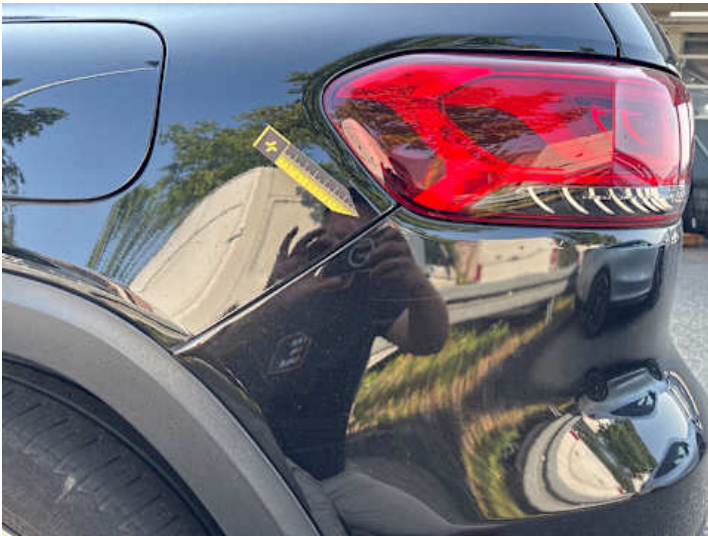
Stoßstange hinten (Unsachgemäß instand gesetzt)
