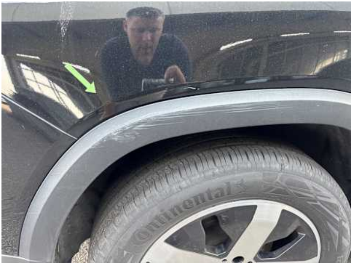
Seitenteil hinten rechts (Kratzer, Delle, Spaltmaße ungenau)
