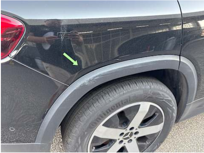
Seitenteil hinten rechts (Kratzer, Delle, Spaltmaße ungenau)
