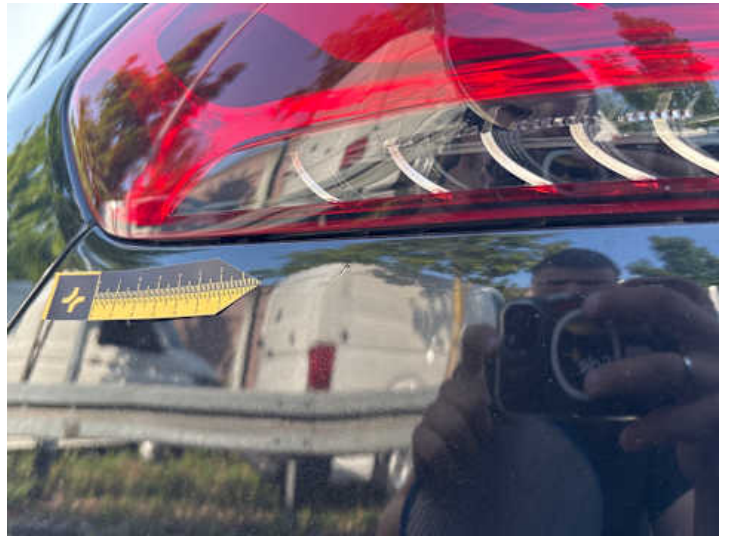
Stoßstange hinten (Unsachgemäß instand gesetzt)
