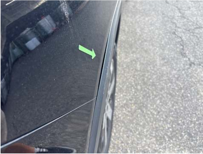
Seitenteil hinten rechts (Kratzer, Delle, Spaltmaße ungenau)
