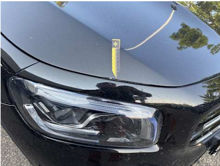
Motorhaube (Unsachgemäß instand gesetzt)
