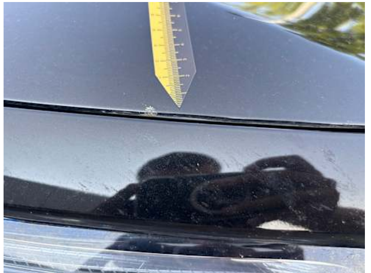
Motorhaube (Unsachgemäß instand gesetzt)
