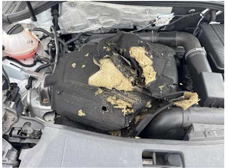
Motorhaube (Anderer Schaden): Tierversiss
