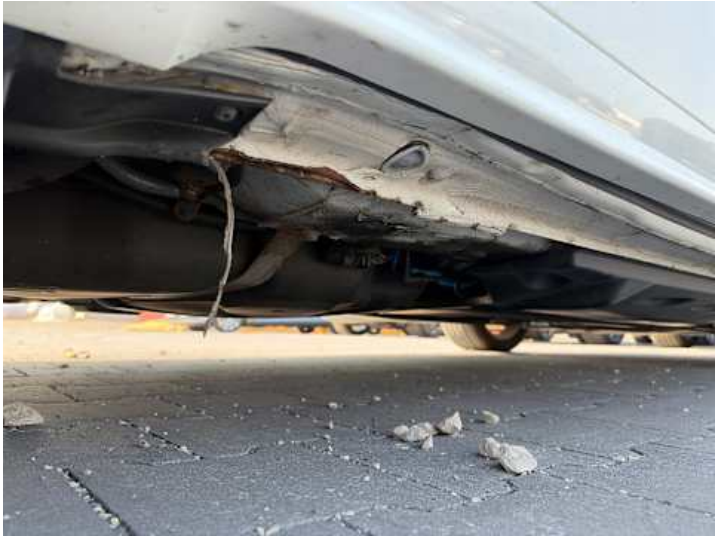
Schweller rechts (Rost, Verformung)
