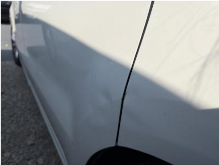
Türe hinten links (Verformung)
