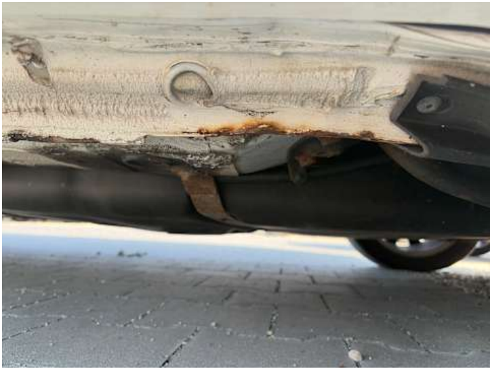
Schweller links (Rost)
