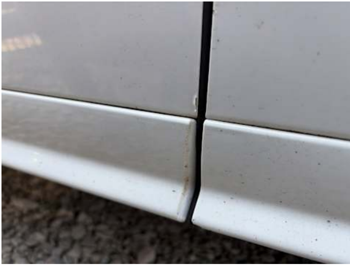
Türe hinten rechts (Lackschaden)
