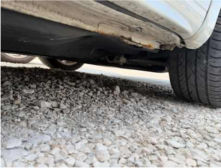
Schweller rechts (Rost, Verformung)
