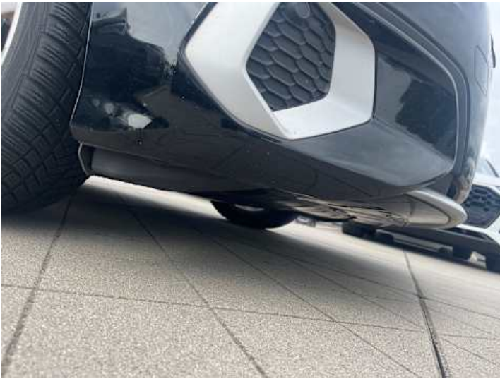
Stoßstange vorne (Kratzer, Lackschaden)
