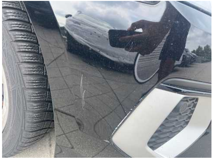
Stoßstange vorne (Kratzer, Lackschaden)
