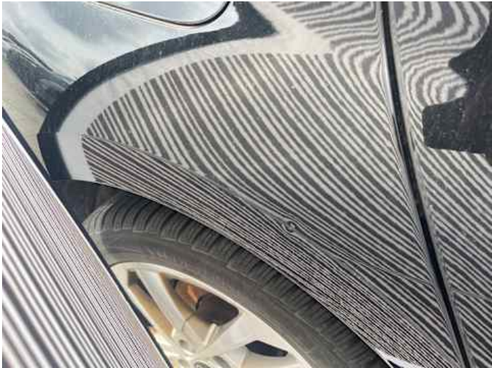
Seitenteil hinten rechts (Delle)
