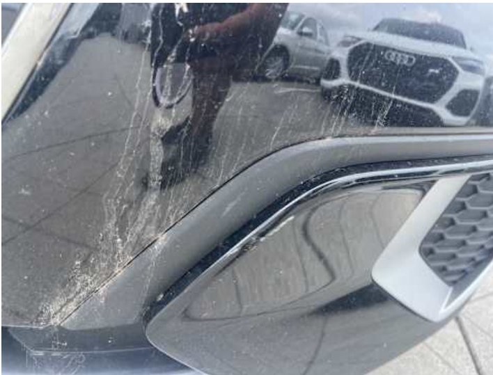
Stoßstange vorne (Kratzer, Lackschaden)
