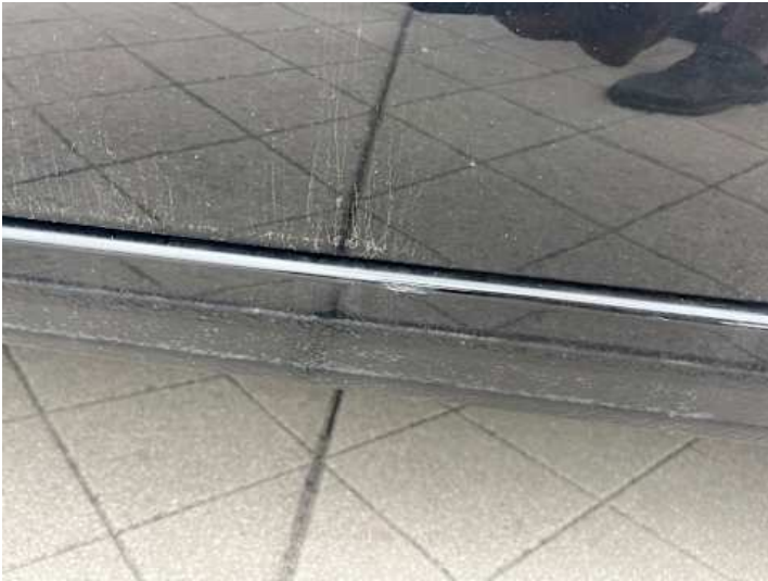
Schweller links (Kratzer, Lackschaden)
