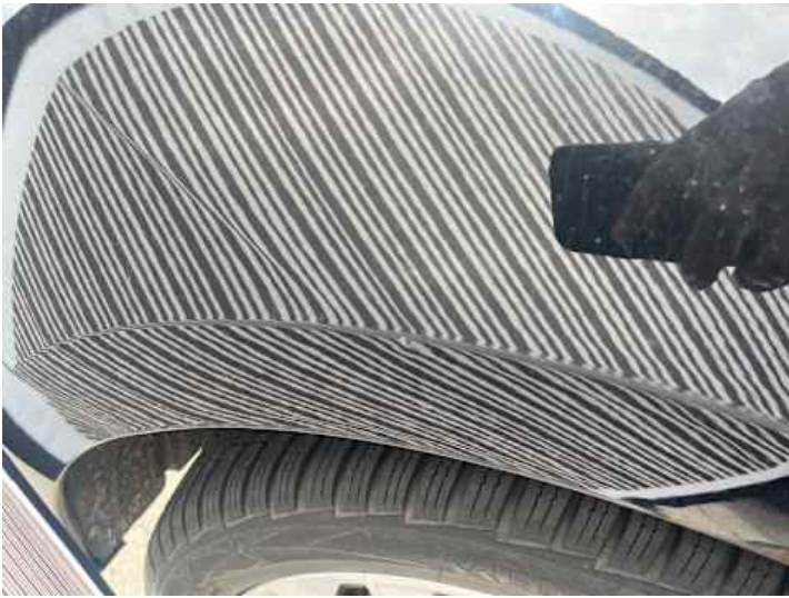
Seitenteil hinten rechts (Delle)
