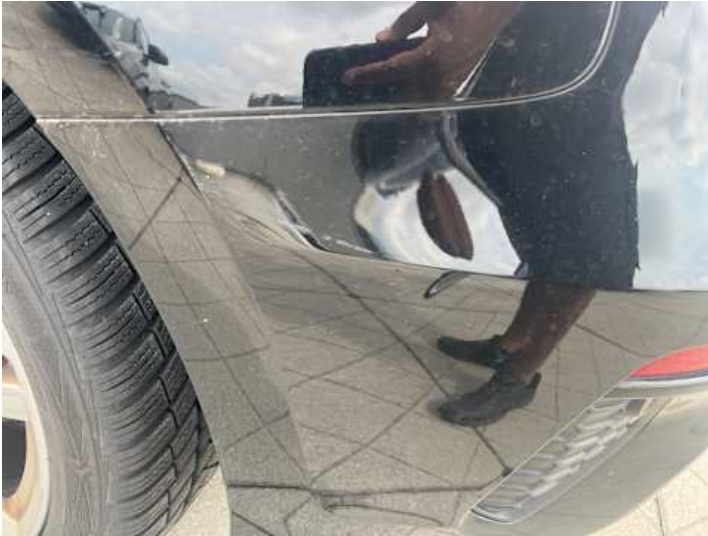
Stoßstange hinten (Lackschaden)
