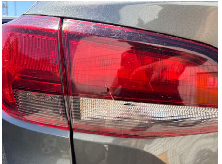
Rücklicht (links) (Riss/Bruch)
