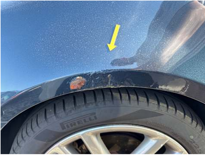
Kotflügel vorne links (Rost)
