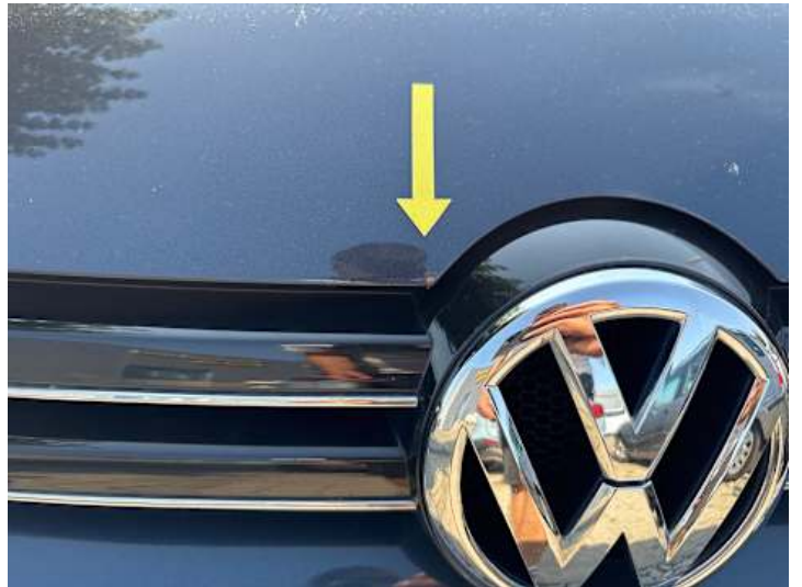
Motorhaube (Steinschlag, Rost)
