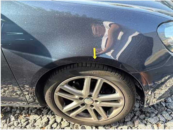
Kotflügel vorne rechts (Rost)
