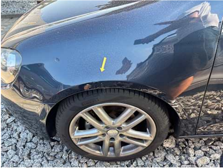
Kotflügel vorne links (Rost)
