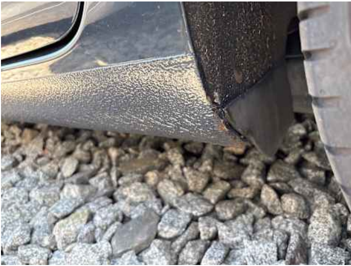
Schweller links (Rost)
