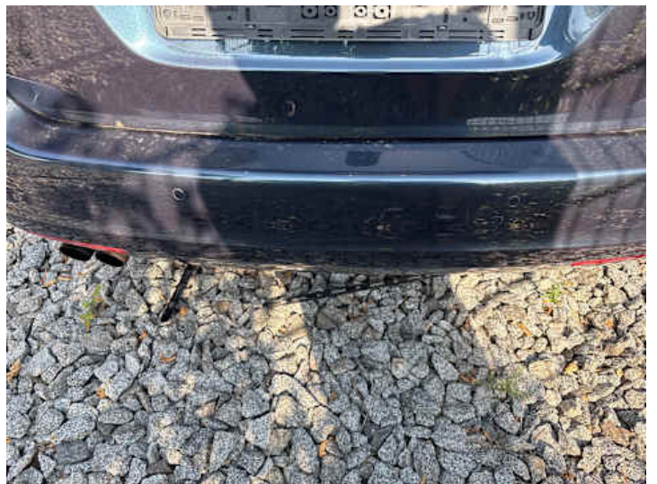
Stoßstange hinten (Kratzer)
