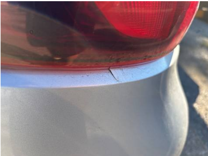
Stoßstange hinten (Riss/Bruch)
