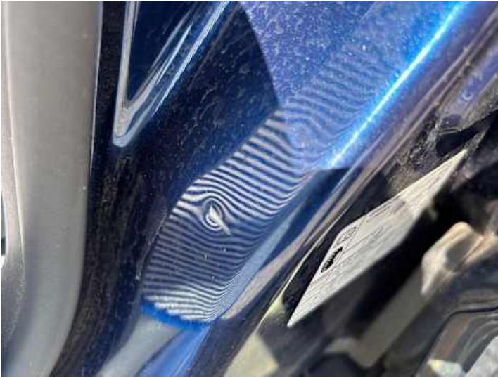
Schweller links (Delle, Kratzer)
