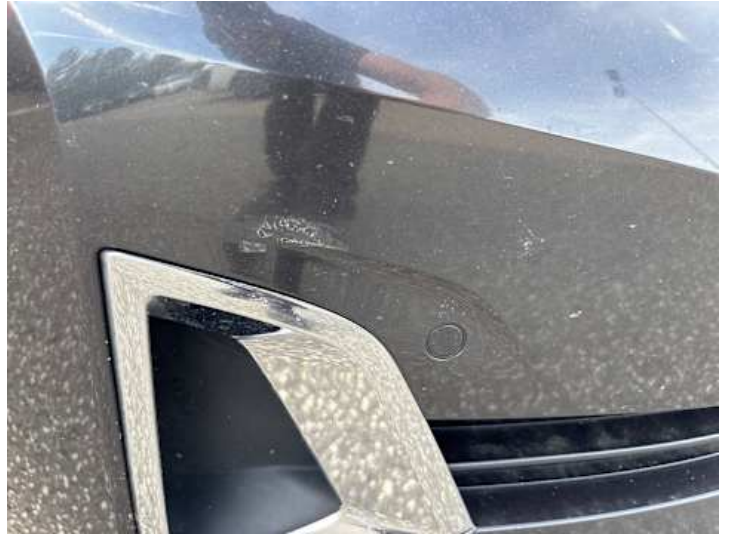
Stoßstange vorne (Kratzer, Lackschaden)
