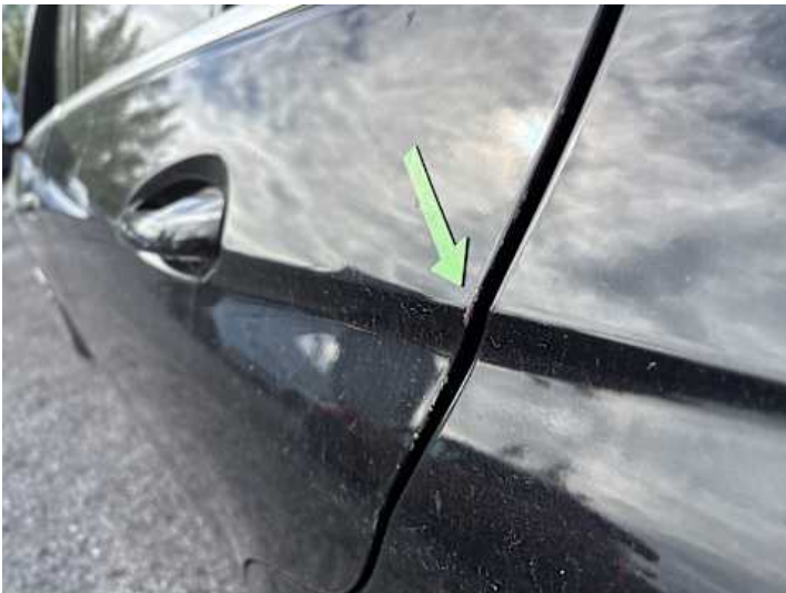
Türe hinten links (Lackschaden, Kratzer)
