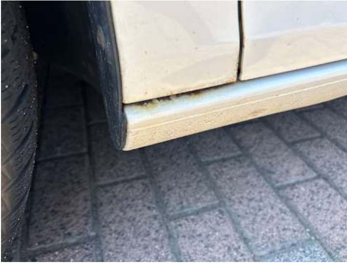
Schweller links (Rost)
