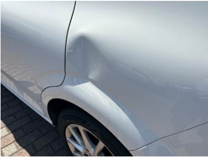
Seitenteil hinten links (Verformung)
