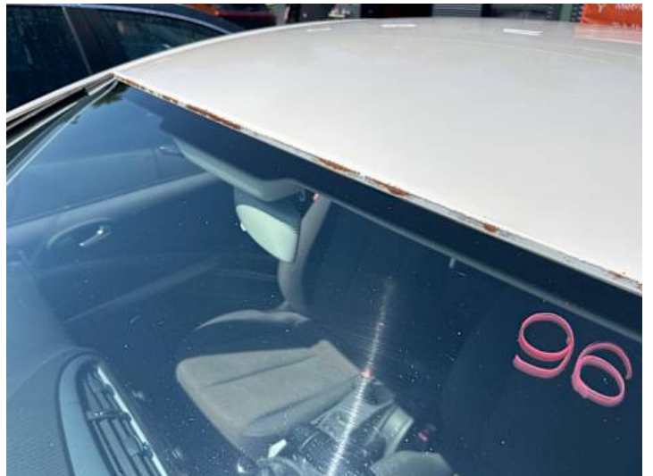
Dach (Kratzer, Rost)
