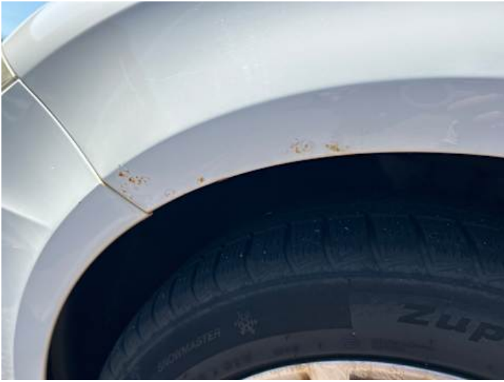
Kotflügel vorne links (Rost)
