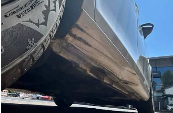
Schweller rechts (Rost)
