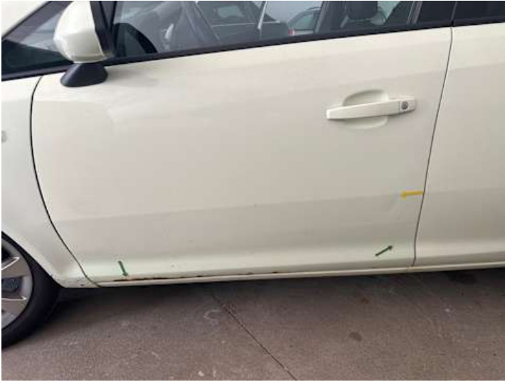
Fahrtür (Delle, Rost)
