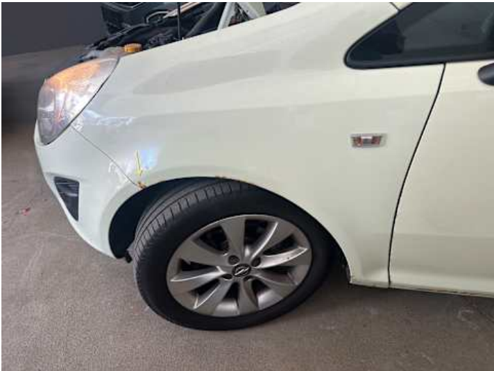
Kotflügel vorne links (Rost)
