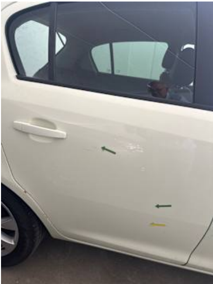
Türe hinten rechts (Kratzer, Rost)
