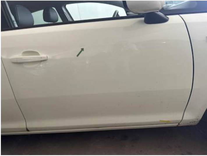
Beifahrtür (Rost, Kratzer)
