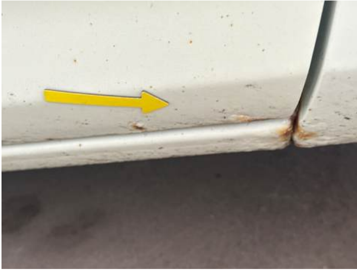
Beifahrtür (Rost, Kratzer)
