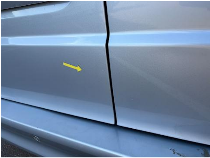
Heckklappe (Kratzer, Delle)
