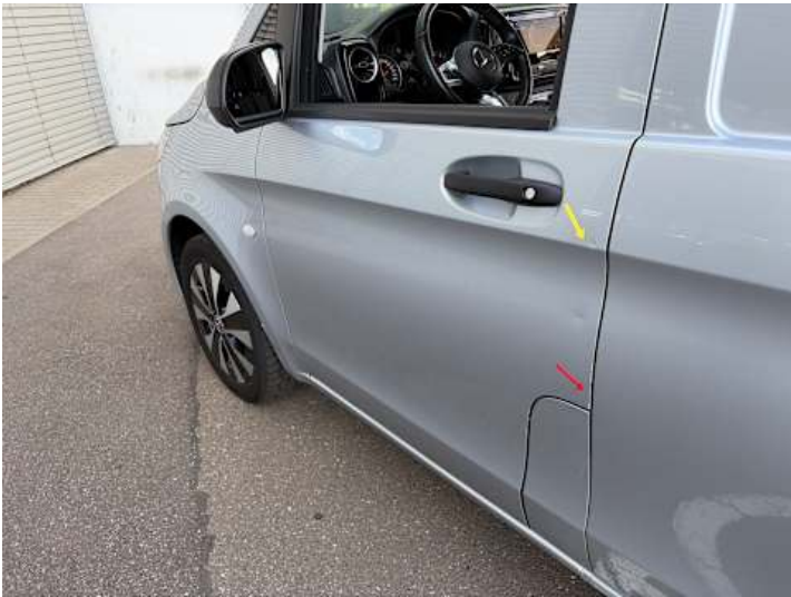
Fahrtür (Kratzer, Delle)
