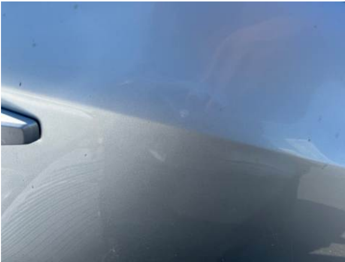
Türe hinten rechts (Kratzer, Lackschaden)
