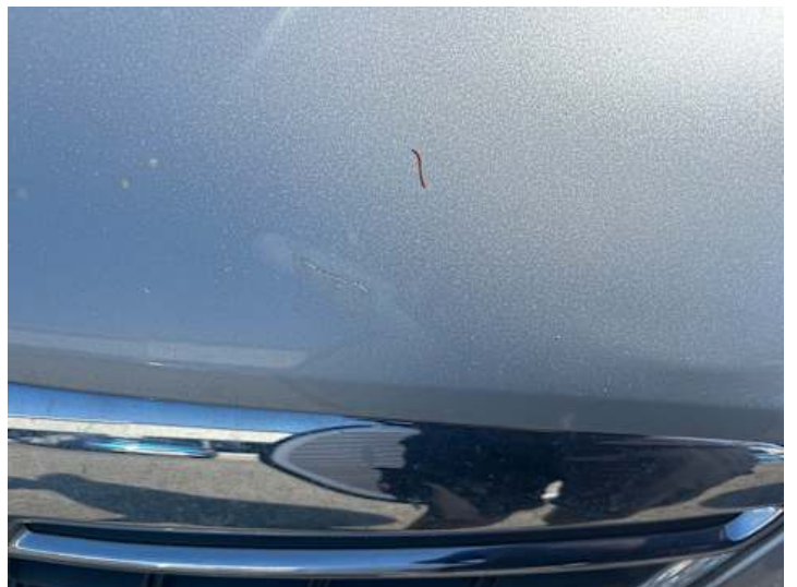
Motorhaube (Kratzer, Spaltmaße ungenau, Unsachgemäß instand gesetzt)
