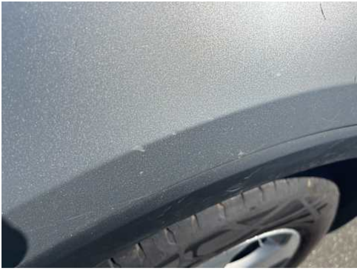
Kotflügel vorne links (Kratzer, Lackschaden)
