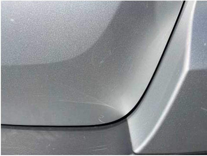
Heckklappe (Kratzer, Lackschaden)
