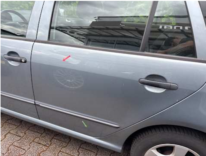
Türe hinten links (Kratzer, Delle)
