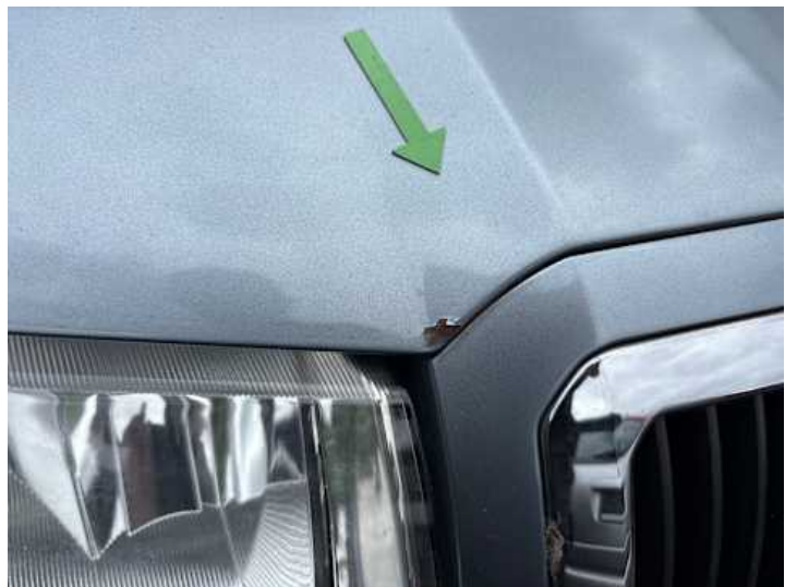
Motorhaube (Lackschaden, Rost)
