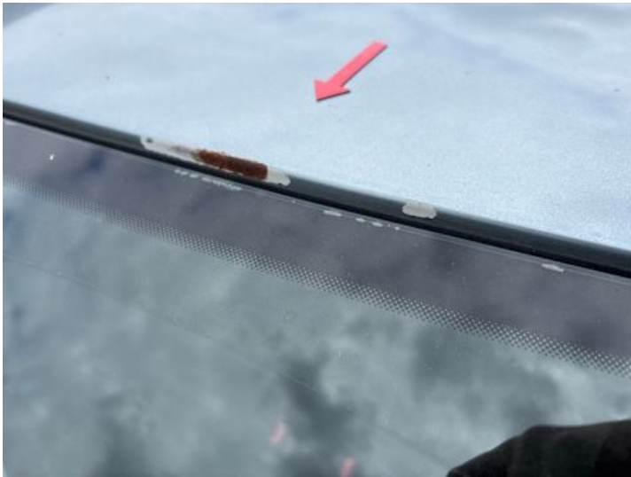
Dach (Lackschaden, Rost)
