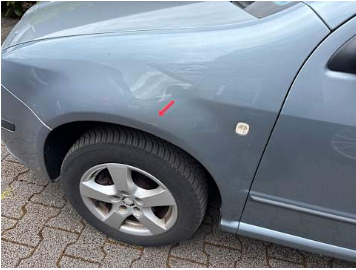
Kotflügel vorne links (Delle)
