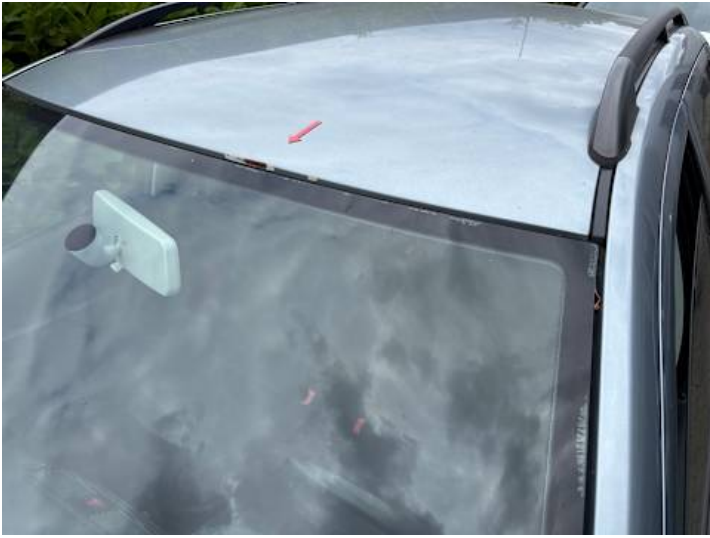
Dach (Lackschaden, Rost)
