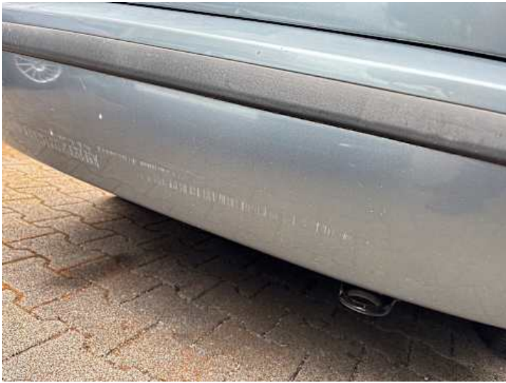
Stoßstange hinten (Kratzer, Lackschaden)
