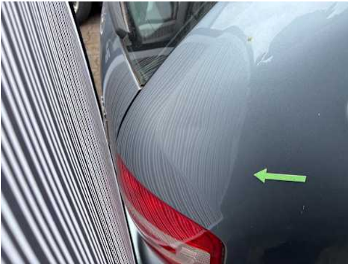
Seitenteil hinten rechts (Kratzer, Delle)
