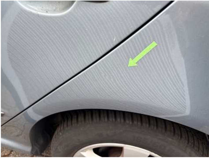
Seitenteil hinten links (Delle)
