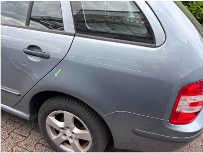
Seitenteil hinten links (Delle)
