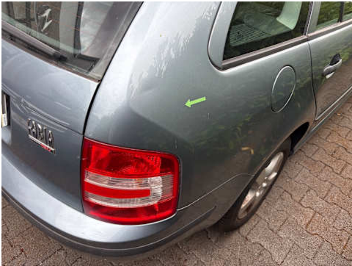
Seitenteil hinten rechts (Kratzer, Delle)
