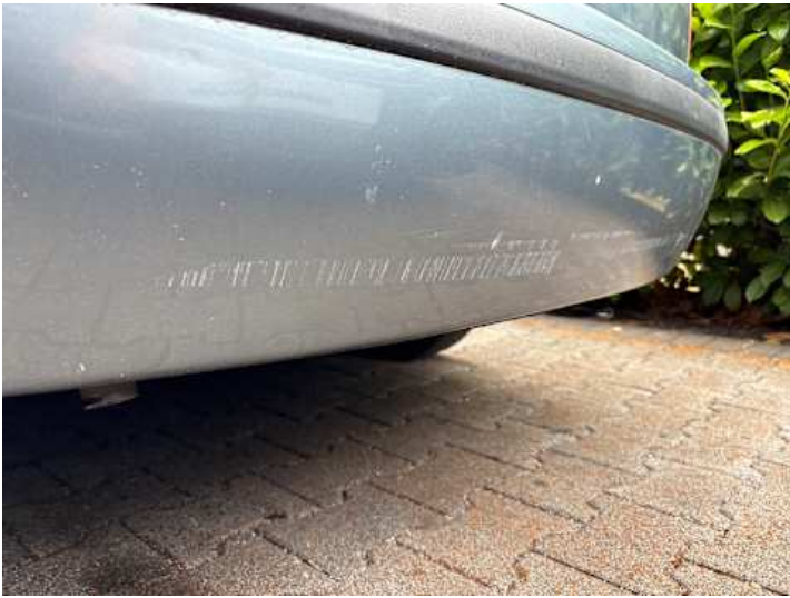
Stoßstange hinten (Kratzer, Lackschaden)
