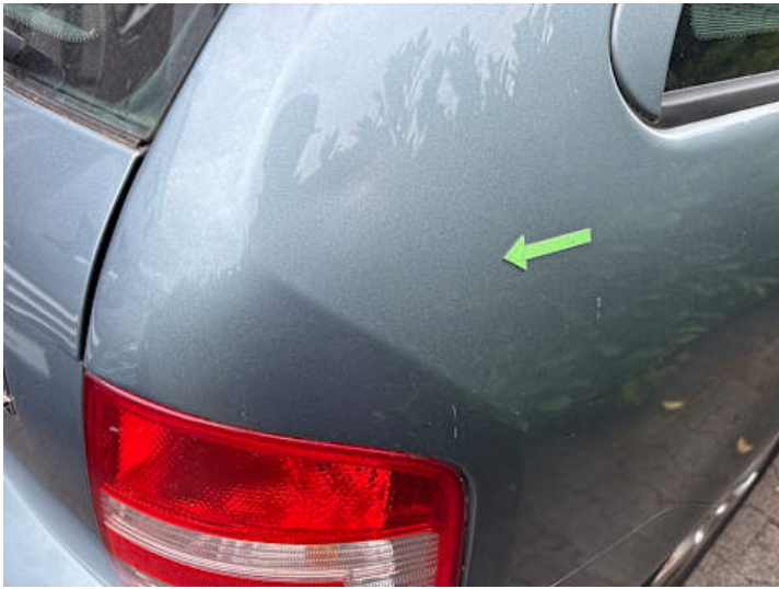
Seitenteil hinten rechts (Kratzer, Delle)
