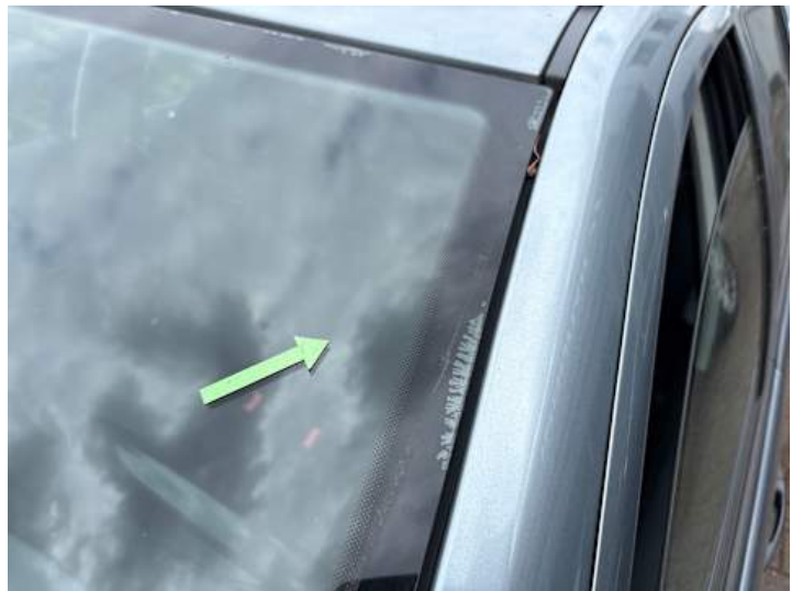
Windschutzscheibe (Anderer Schaden): Undicht
