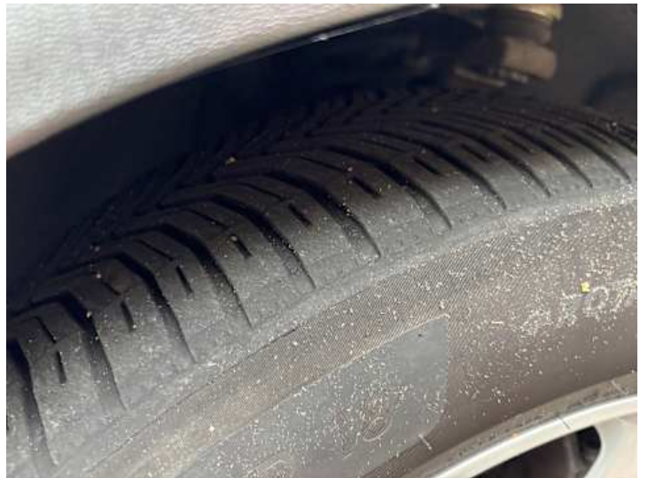
Rad (vehicle.damage-label.porous, Ungleichmäßig abgefahren)
