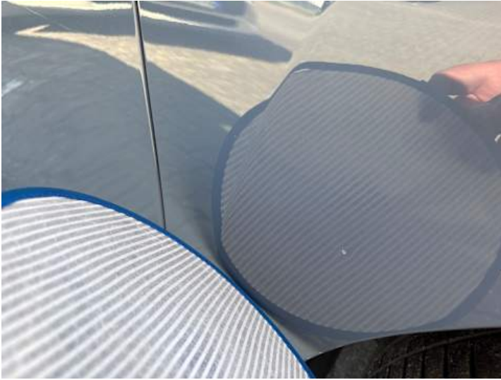
Kotflügel vorne rechts (Kratzer, Delle)
