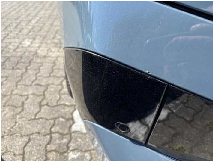
Stoßstange hinten (Lackschaden)
