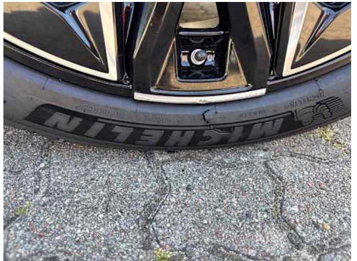
Rad (Kratzer, Riss/Bruch)
