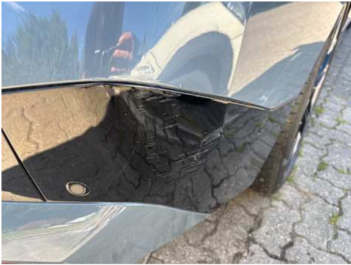
Stoßstange hinten (Lackschaden)
