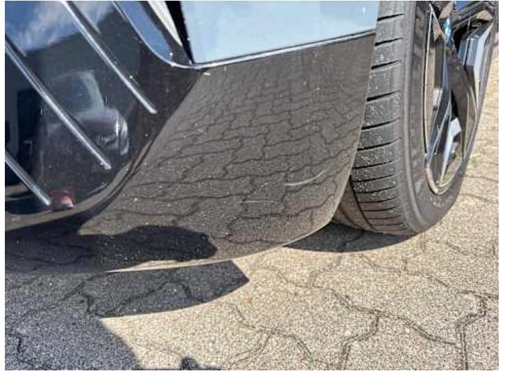
Stoßstange vorne (Lackschaden, Kratzer, Riss/Bruch)
