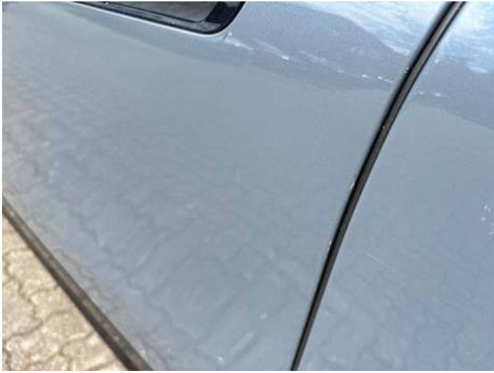
Fahrtür (Kratzer, Verformung)
