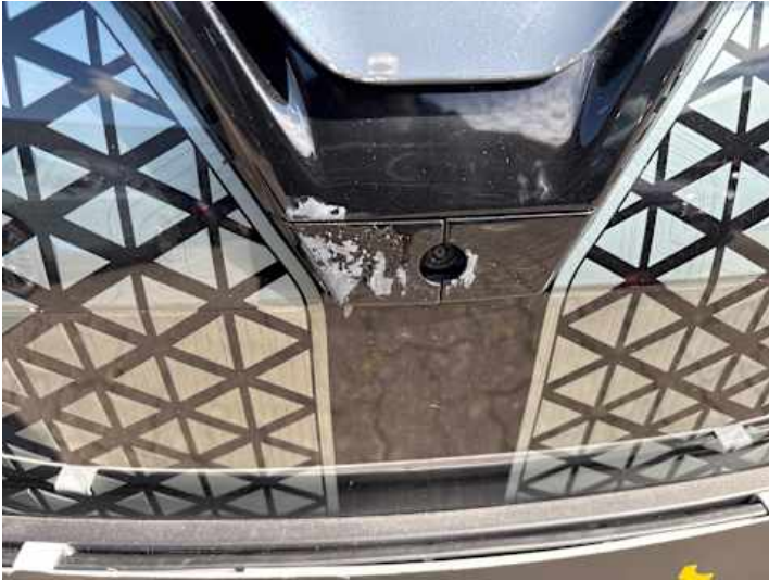
Stoßstange vorne (Lackschaden, Kratzer, Riss/Bruch)
