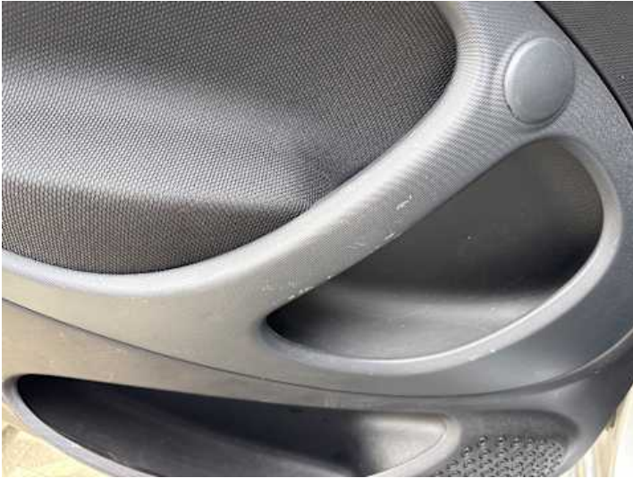
Innenraum (Verschleiß, Kratzer)
