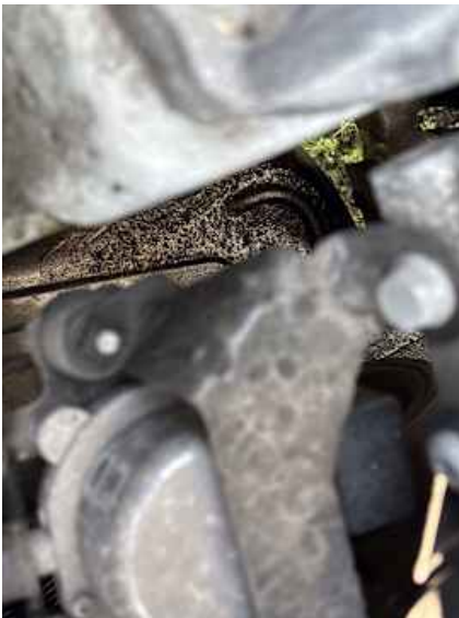
Motorhaube (Anderer Schaden): Motorraum Boden Öl Film
