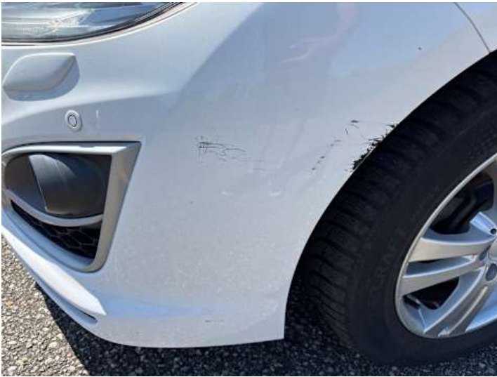
Stoßstange vorne (Kratzer, Lackschaden)
