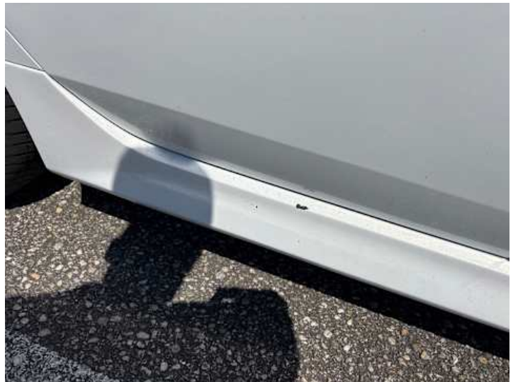
Schweller rechts (Lackschaden)
