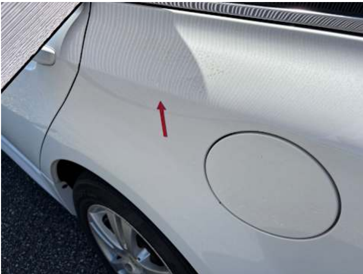
Seitenteil hinten links (Delle)
