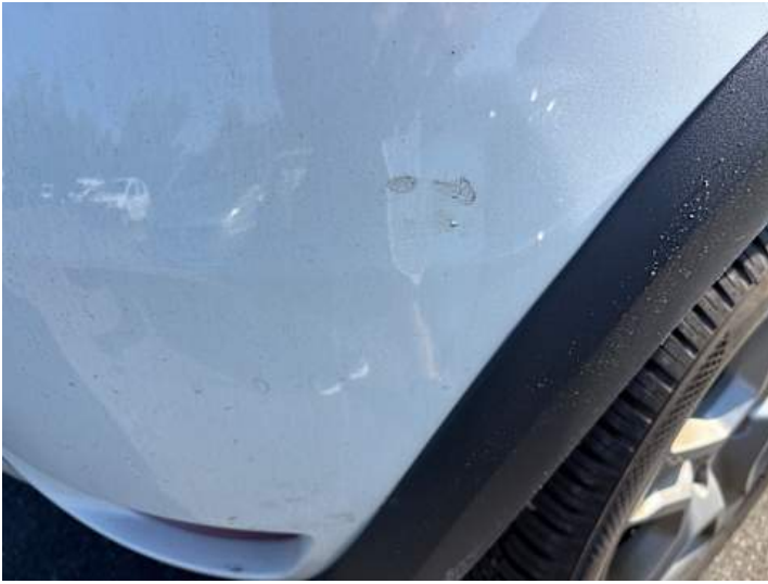
Stoßstange hinten (Kratzer, Lackschaden, Unsachgemäß instand gesetzt)
