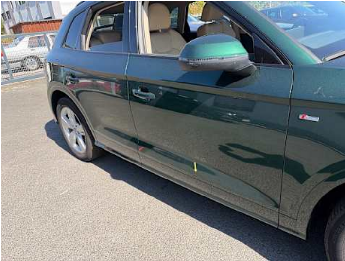
Beifahrertür (Kratzer, Delle)
