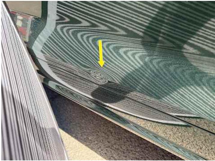
Beifahrertür (Kratzer, Delle)
