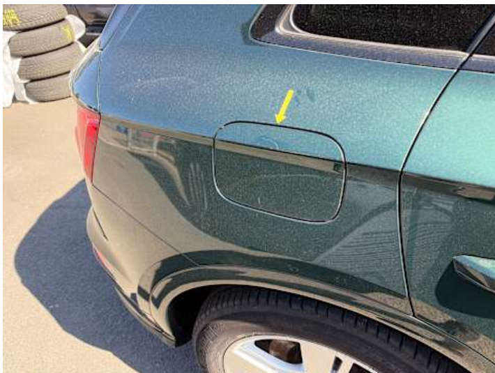
Seitenteil hinten rechts (Kratzer)
