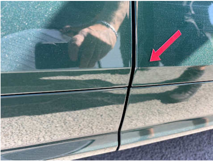
Beifahrertür (Kratzer, Delle)
