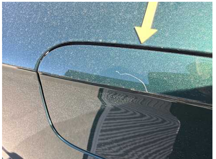
Seitenteil hinten rechts (Kratzer)
