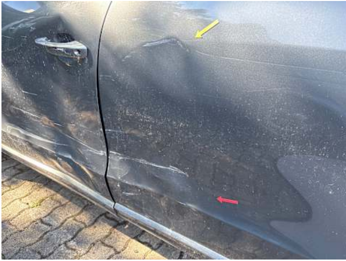
Türe hinten links (Lackschaden, Verformung)
