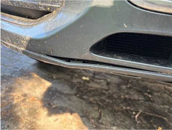
Stoßstange vorne (Lackschaden, Riss/Bruch)
