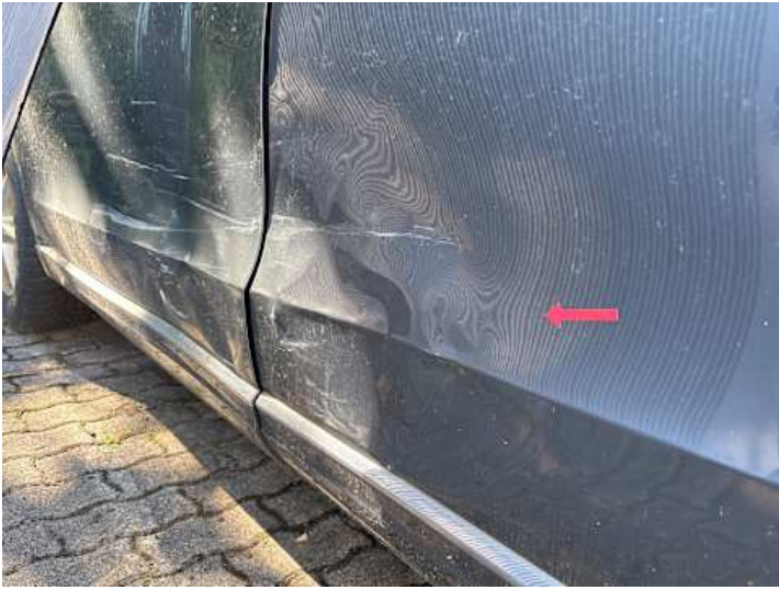
Türe hinten links (Lackschaden, Verformung)
