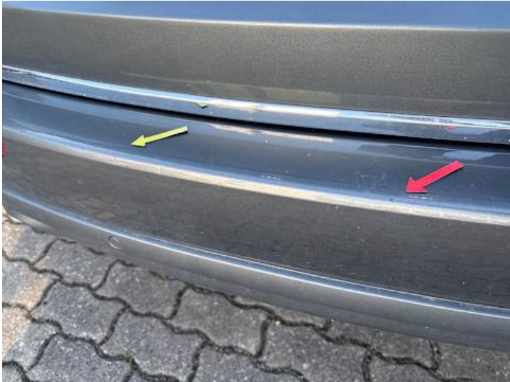
Stoßstange hinten (Kratzer, Lackschaden)
