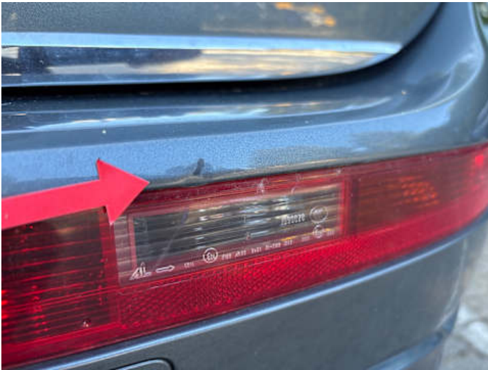
Stoßstange hinten (Lackschaden, Delle)
