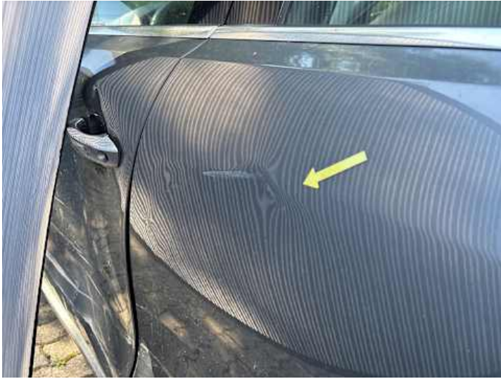
Türe hinten links (Lackschaden, Verformung)
