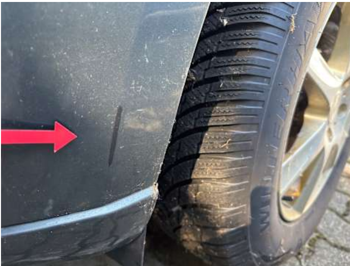
Stoßstange vorne (Lackschaden)
