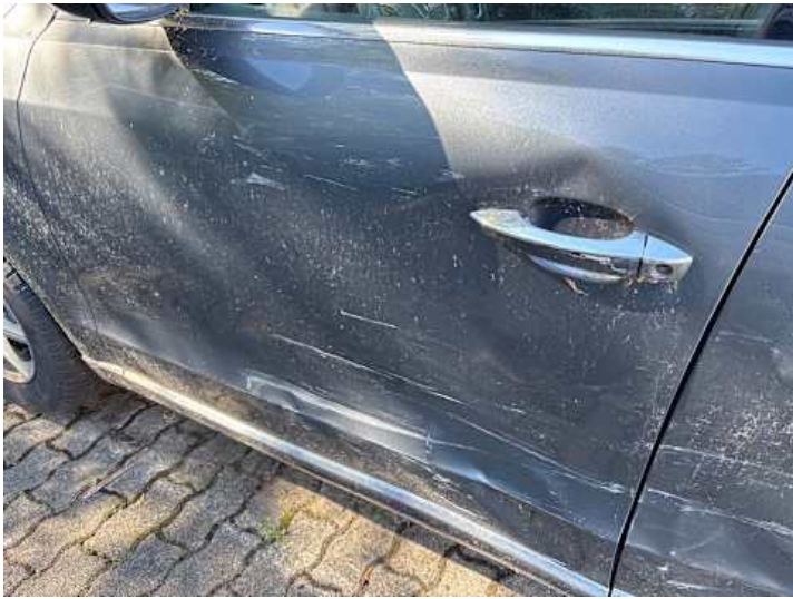
Fahrertür (Verformung, Lackschaden, Riss/Bruch)
