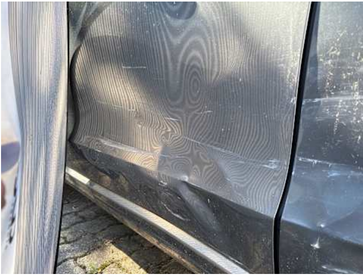
Fahrertür (Verformung, Lackschaden, Riss/Bruch)
