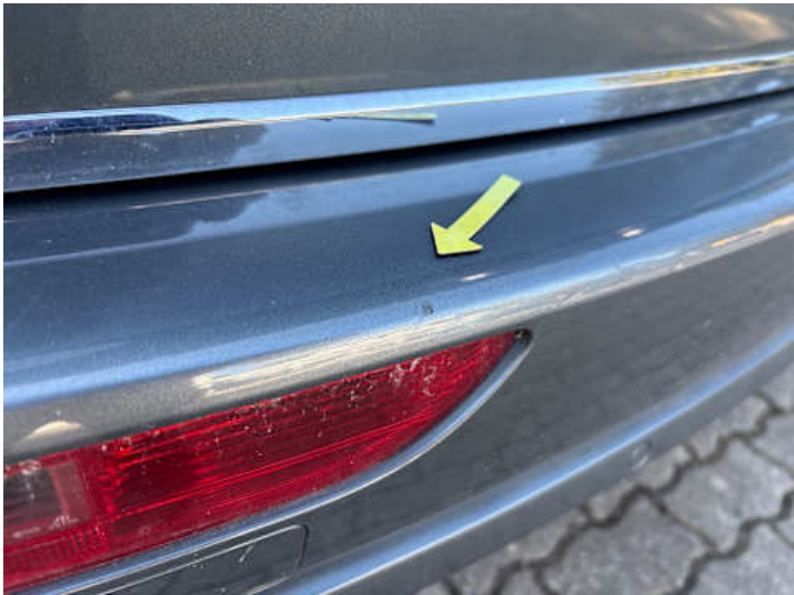
Stoßstange hinten (Kratzer, Lackschaden)
