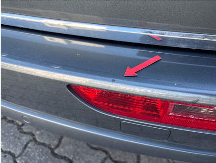
Stoßstange hinten (Kratzer, Lackschaden)
