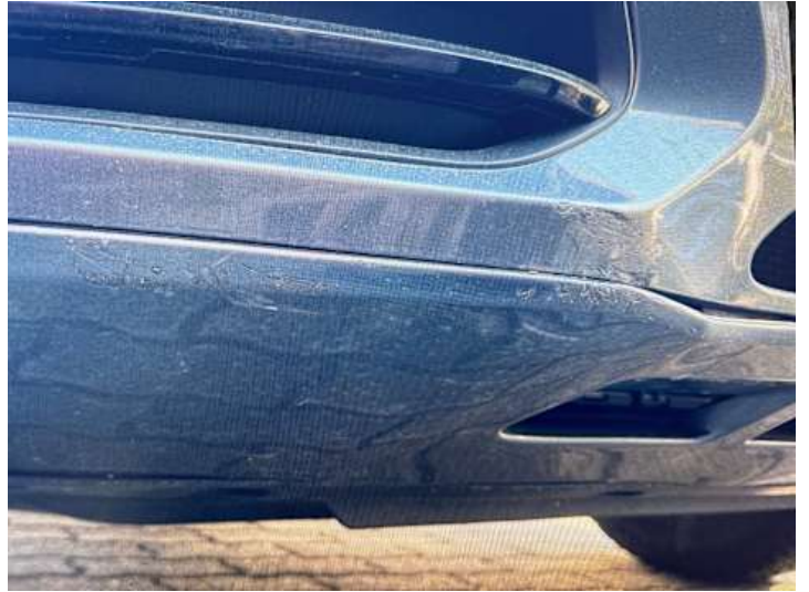
Stoßstange vorne (Lackschaden, Kratzer)
