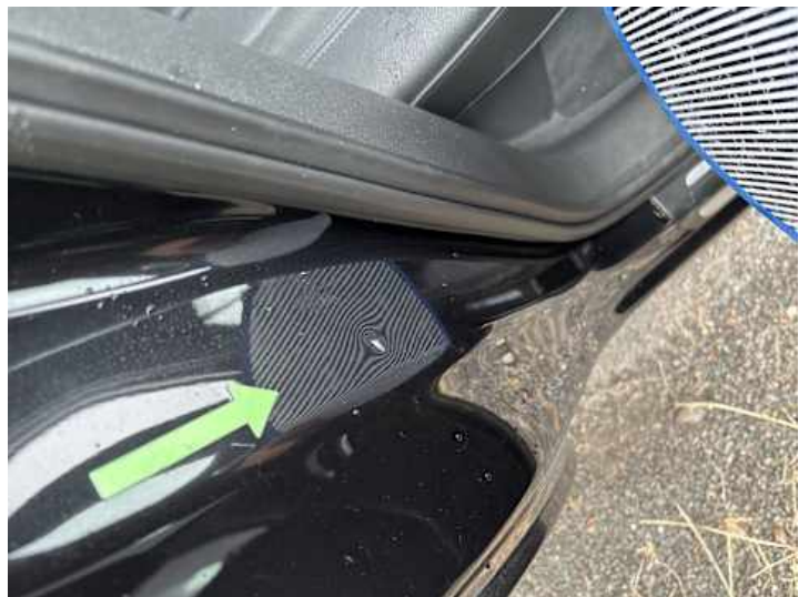
Türe hinten rechts (Kratzer, Delle)
