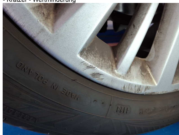
Beschädigung #3: Rad/Reifen: Leichtmetallfelge hinten rechts - Kratzer - Wertminderung
