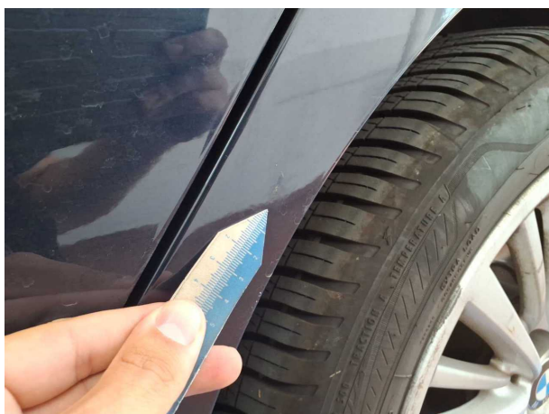
Beschädigung #1: Seitenwand links: Seitenwand - Geruch - auslegen / polieren
