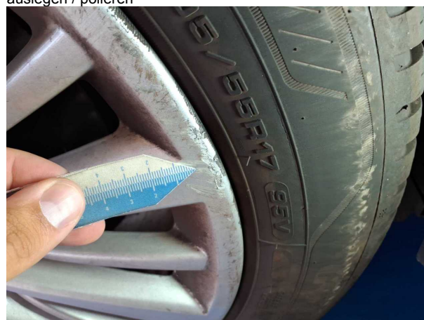
Beschädigung #3: Rad/Reifen: Leichtmetallfelge hinten rechts - Kratzer - Wertminderung
