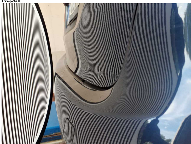
Beschädigung #7: Heckklappe/-tür: Heckklappe - Delle(n) - sanft instandsetzen
