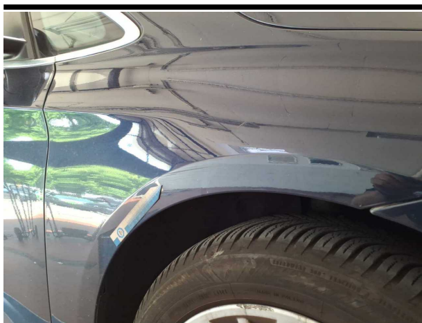
Beschädigung #8: Kotflügel rechts: Kotflügel rechts - Kratzer - instandsetzen und lackieren
