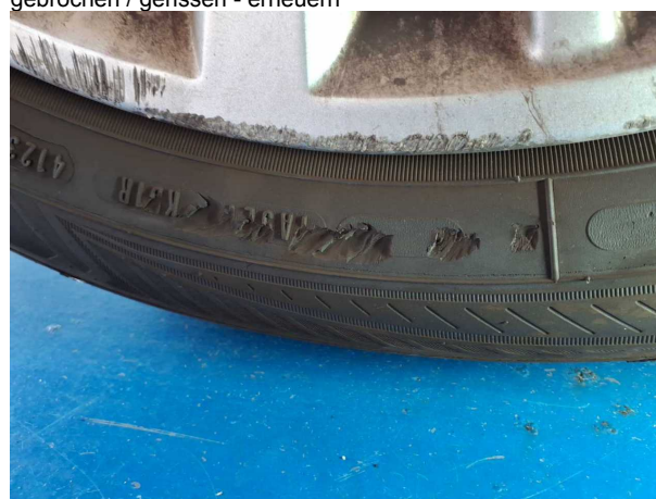
Beschädigung #5: Rad/Reifen: Reifen hinten rechts - gebrochen / gerissen - erneuern
