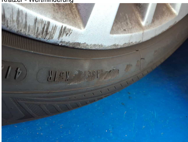
Beschädigung #5: Rad/Reifen: Reifen hinten rechts - gebrochen / gerissen - erneuern
