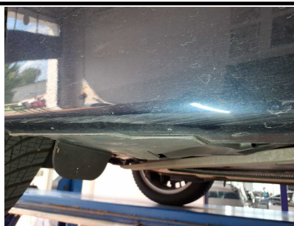
Beschädigung #6: Schweller rechts: Verkleidung - Kratzer - Smart Repair
