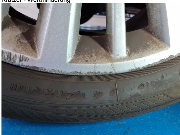
Beschädigung #3: Rad/Reifen: Leichtmetallfelge hinten rechts - Kratzer - Wertminderung
