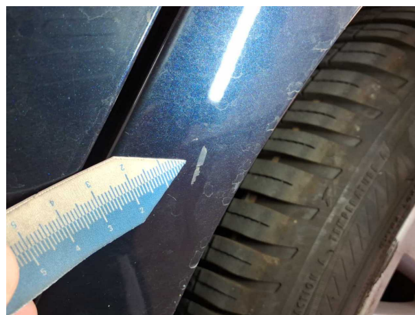
Beschädigung #1: Seitenwand links: Seitenwand - Geruch - auslegen / polieren
