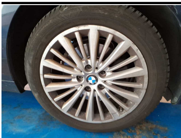
Beschädigung #4: Rad/Reifen: Leichtmetallfelge vorn rechts - Kratzer - Wertminderung
