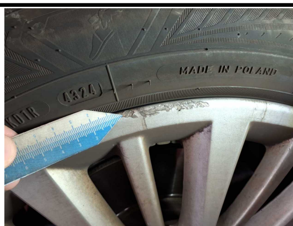
Beschädigung #4: Rad/Reifen: Leichtmetallfelge vorn rechts - Kratzer - Wertminderung
