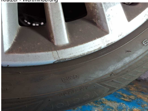
Beschädigung #4: Rad/Reifen: Leichtmetallfelge vorn rechts - Kratzer - Wertminderung
