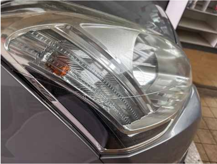
Scheinwerfer (rechts) (Anderer Schaden): Porös
