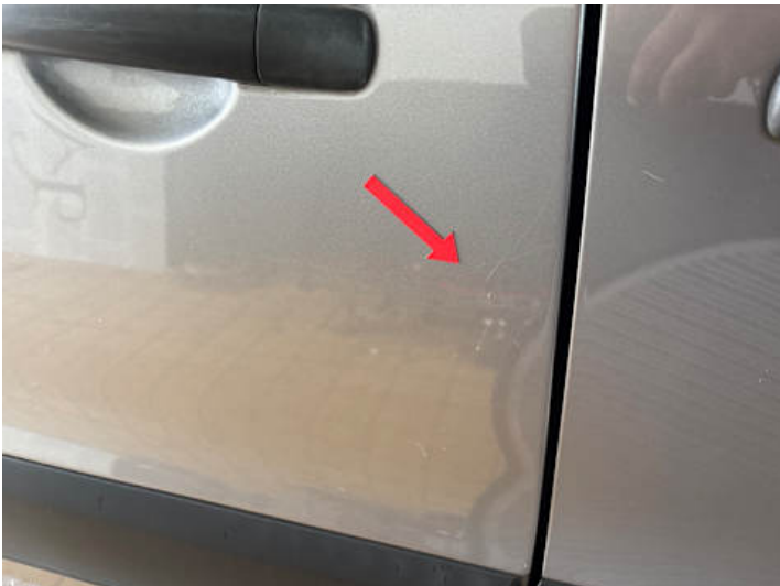
Türe hinten rechts (Kratzer)
