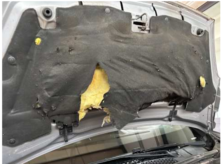
Motorhaube (Anderer Schaden): Dämmung
