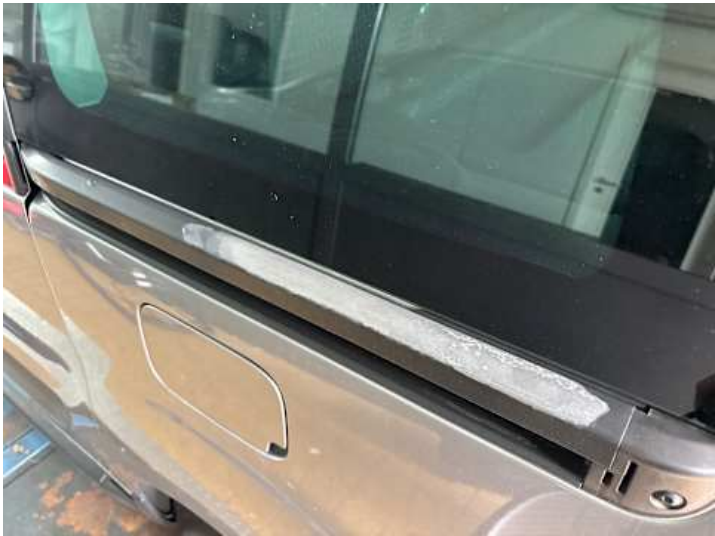
Seitenteil hinten links (Lackschaden)
